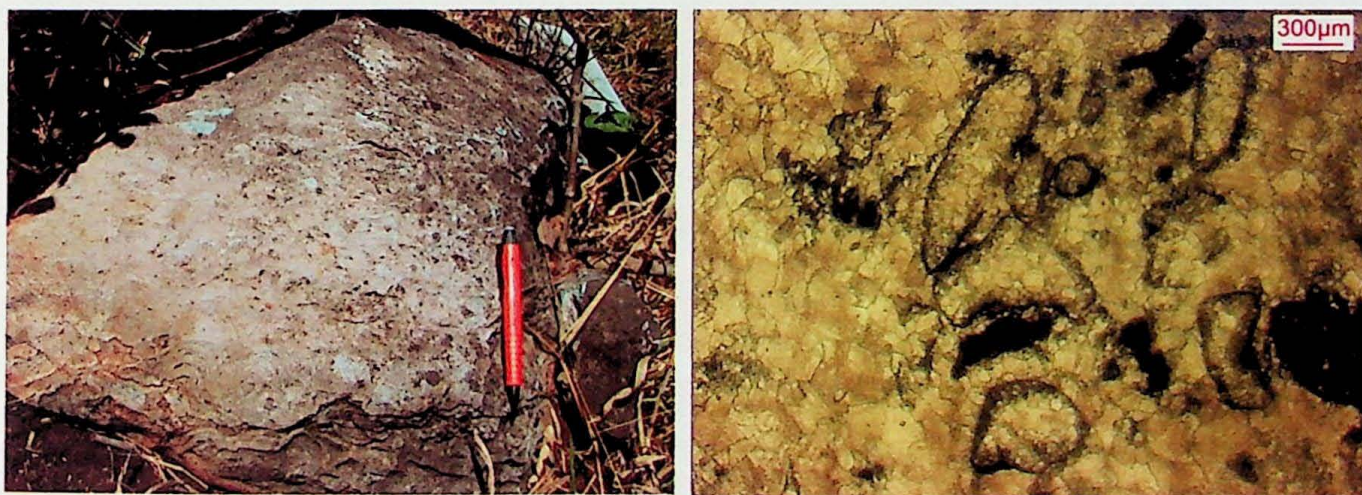
Figura 8.1.5 - Fácies Bllhd, à esquerda: estromatólitos em dolomititos, à direita: possíveis microfítólitos (seção delgada).
