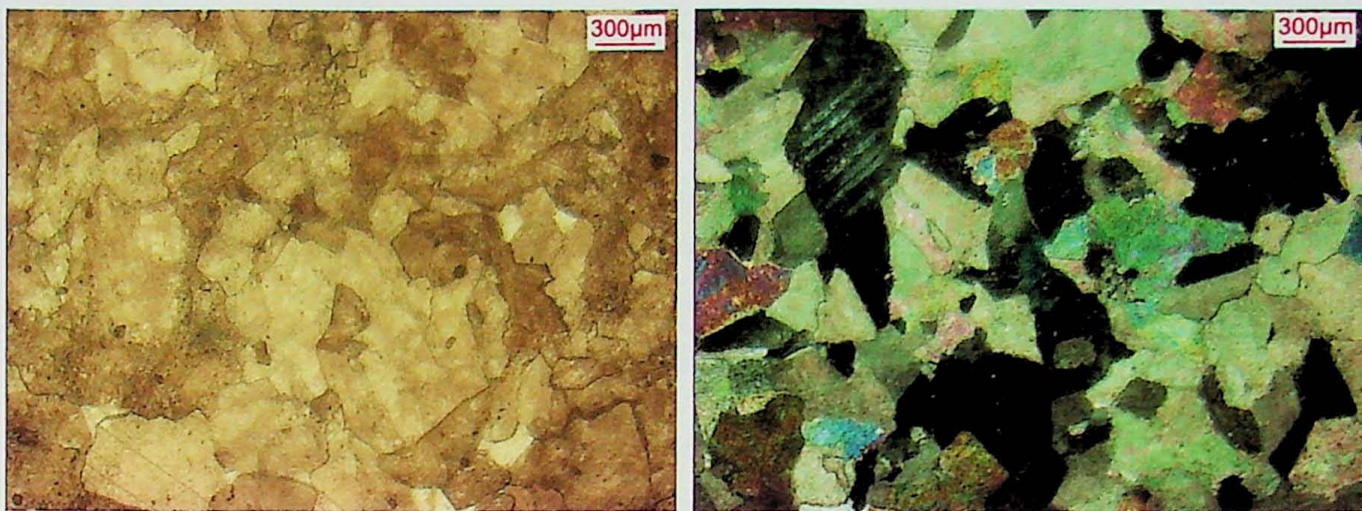
Figura 8.1.6 - Porção na qual a dolomitização teria sido mais intensa (amostra FR-05), à esquerda nicóis paralelos e à direita nicóis cruzados.
