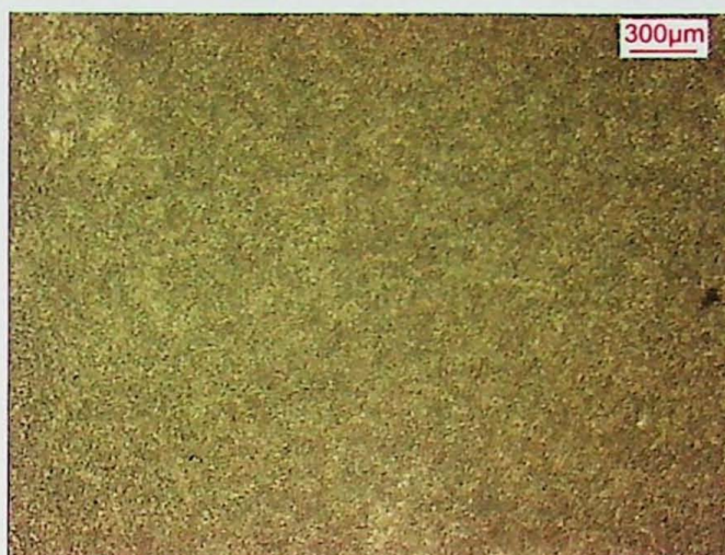
Figura 8.1.7 - Aspecto geral da fácies de Mmd, observar micrítica homogênea e maciça.
