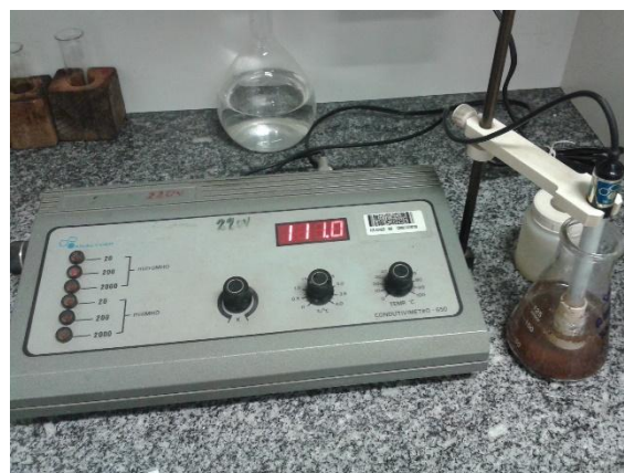
Figura 11 – Medição da CE das suspensões
