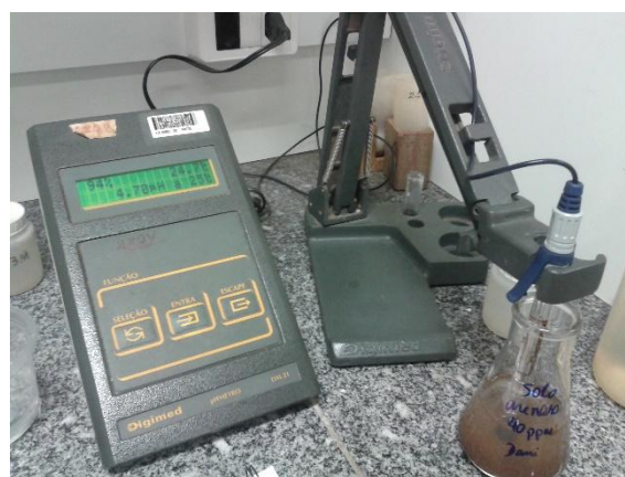
Figura 9 – Medição do pH das suspensões
