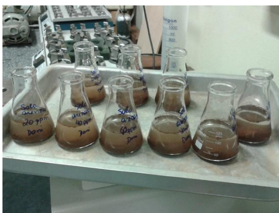
Figura 8 – Suspensões de solo e solução de contaminante
