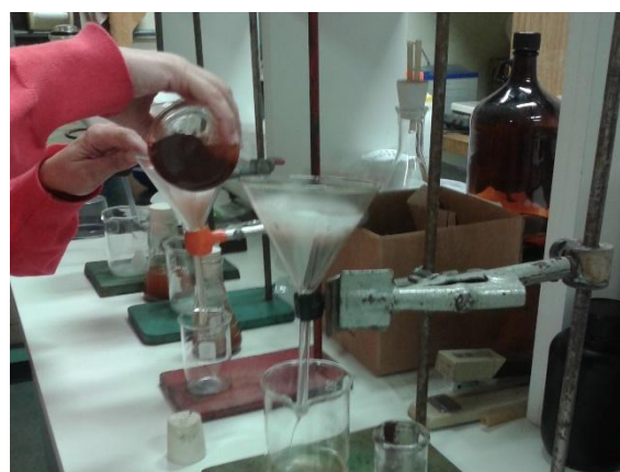
Figura 13 – Filtração das suspensões para obtenção dos extratos finais
