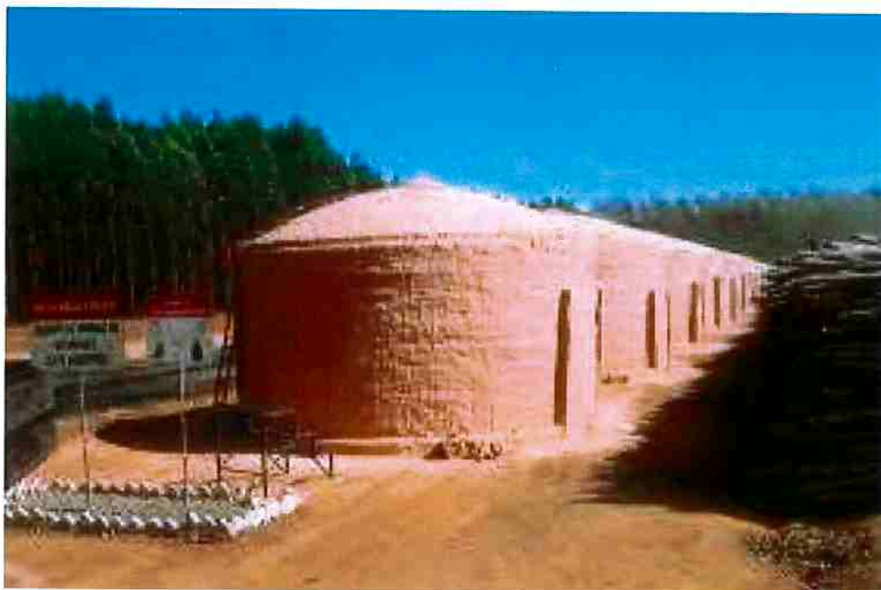
Figura 3: Fornos de alvenaria com melhorias tecnológicas em relação aos fornos Meda. [10].
