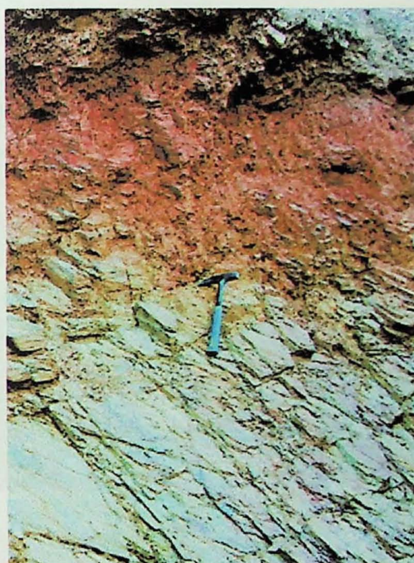
Foto 8: Vista da parede de uma trincheira expondo saprolito de micaxisto, solo saprolítico e cobertura de solo residual.
