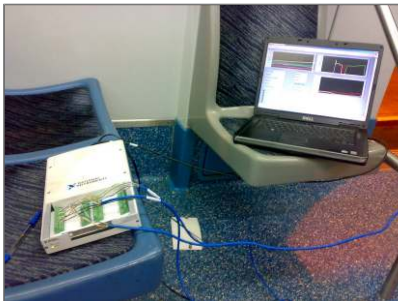
Figura 4.8 – Conexão “notebook” com módulo 505 da National Instruments
