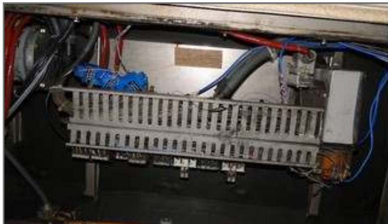
Figura 4.12 – Conexões e cabos na canaleta de cabos do trem
