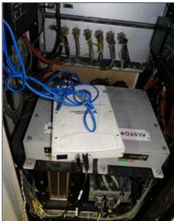
Figura 4.10 – Gravador de dados para transferência e interface com o “notebook”
