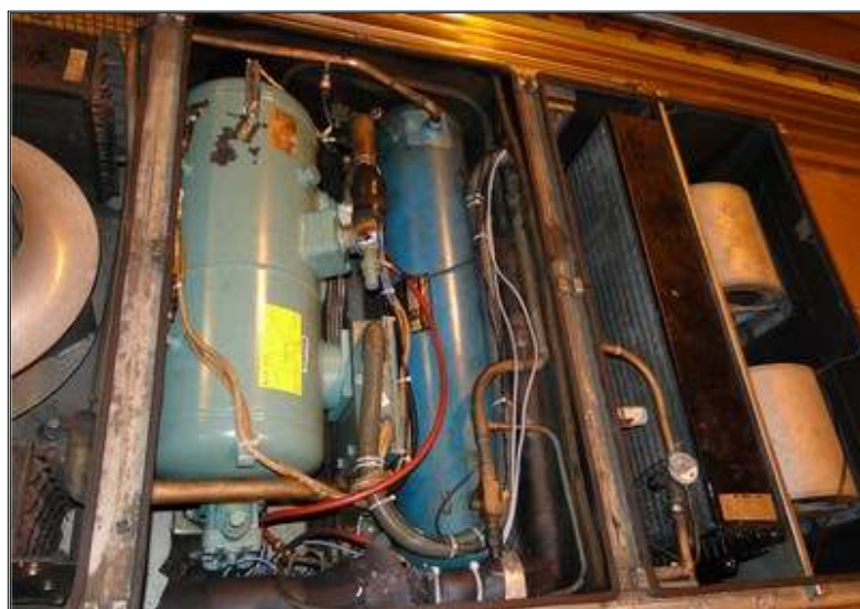
Figura 4.13 – Conexões no compartimento do compressor no teto do trem
