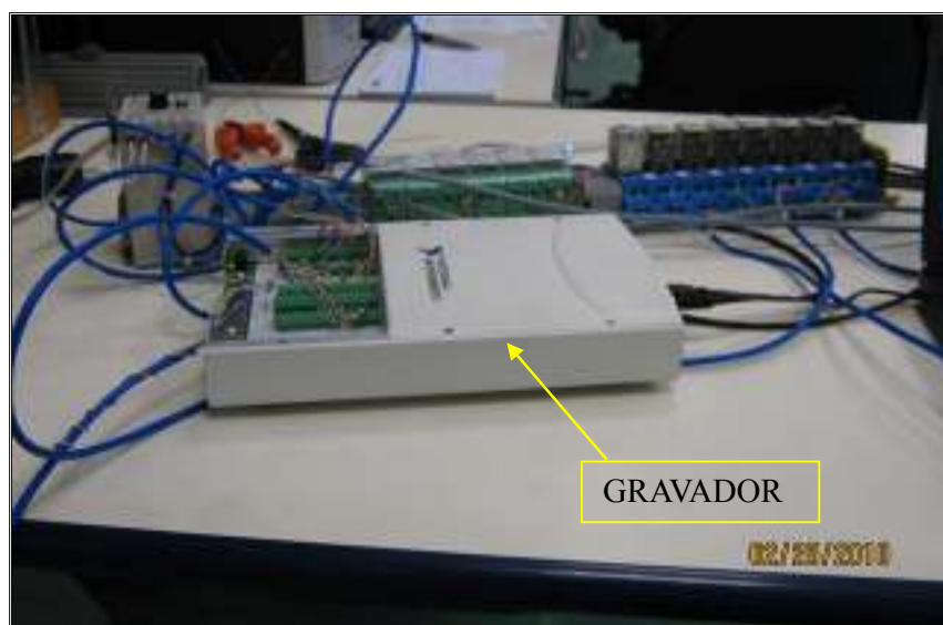
Figura 4.7 – Gravador de dados com módulo 505 da National Instruments
