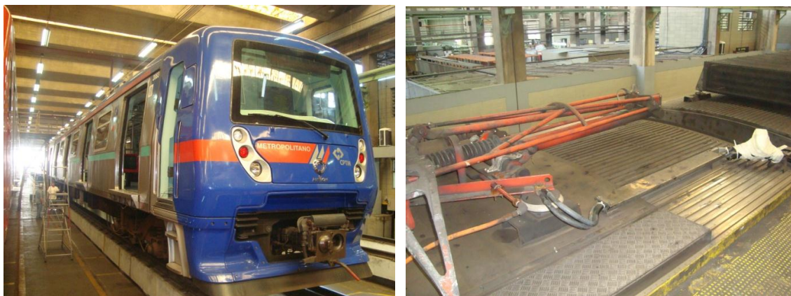
Figura 12 – “Trem-teste” Série 7000 e detalhe do sensor de corrente
