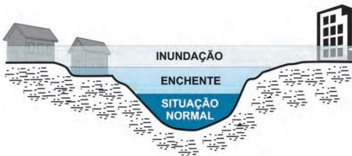
Figura 15 - Perfil esquemático do processo de enchente e inundação Fonte: Min. Cidades/IPT (2007) apud. Amaral e Ribeiro (2015).
