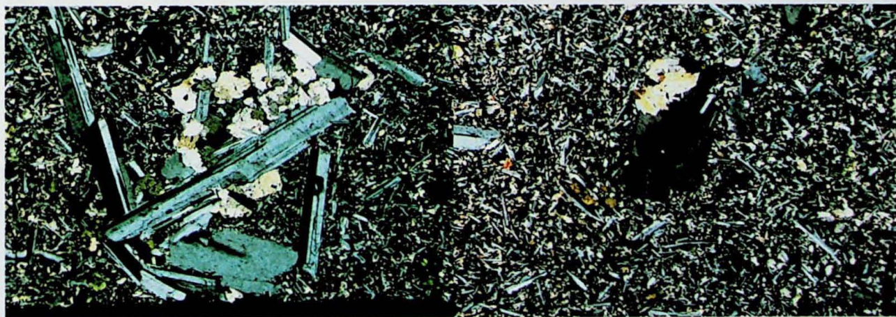
Figuras 11a e 11b. GRUPO I. (lâmina as-552) a) Aglomerado de fenocristais de plagioclásio e piroxênio, em matriz muito fina. Lado maior da imagem 3,25 mm. Nicóis cruzados. b) Fenocristais de plagioclásio e de piroxênio. Detalhe para o zoneamento mineral bem evidente. Lado maior da imagem 3,25 mm. Nicóis cruzados.
