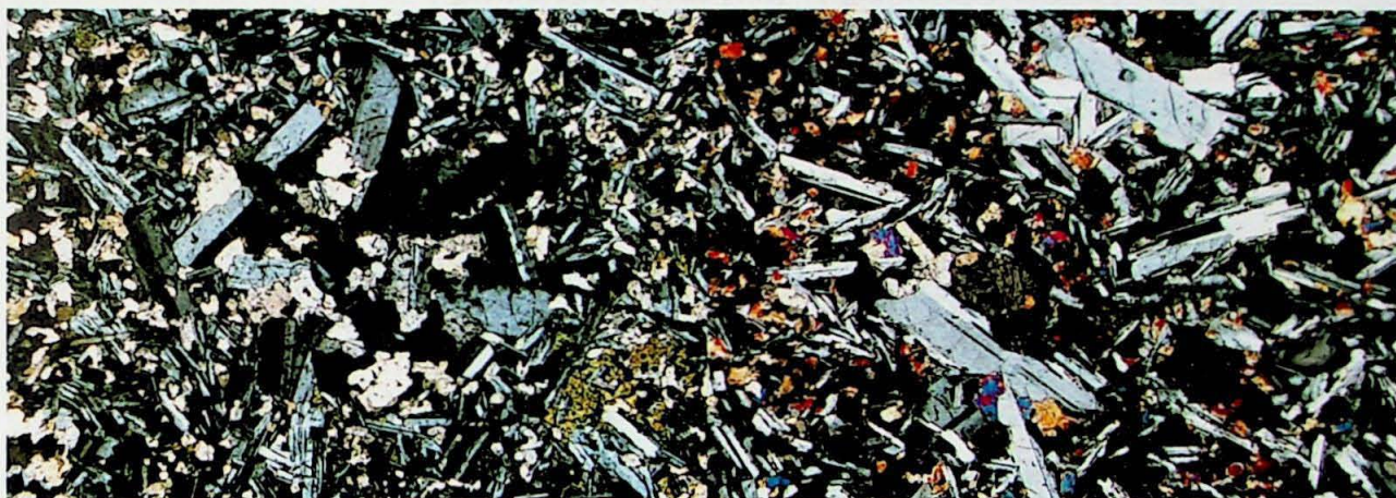
Figuras 18a e 18b. (lâmina as- 525) Textura glomeroporfíritica bem evidente nas duas imagens, com matriz bem desenvolvida. Lado maior das imagens 3,25 mm. Ambas as imagens nicóis cruzados.
