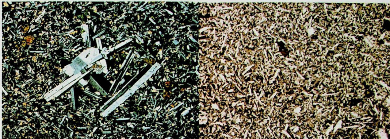
Figuras 12a e 12b. GRUPO I. (lâmina as-141C) Aglomerado de fenocristais de plagioclásio bem formados, destacados na matriz. Nicóis cruzados. b) (lâmina as-552) Aspecto geral do grupo, matriz muito fina. Nicóis paralelos. Ambas as imagens lado maior 3,25 mm.
