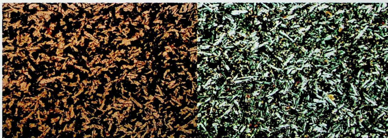
Figuras 13a e 13b. GRUPO II. (lâmina as-546) a) Observa-se matriz ligeiramente mais grossa do que o Grupo 1. Lado maior das imagens 3,25 mm. Nicóis paralelos. b) Nicóis cruzados.
