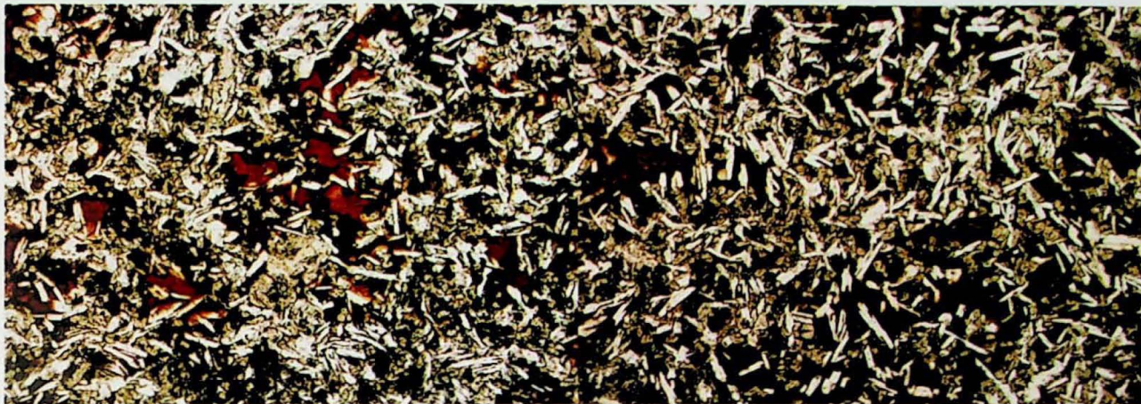
Figuras 14a e 14b. GRUPO I. (lâmina as-85) a) Interstícios alterados relativamente abundantes em comparação aos outros grupos. b) (lâmina as-539) Detalhe para o mineral de alteração verde, provável clorofaeita. Ambas as fotos nicóis paralelos. Lado maior das imagens 3,25 mm.
