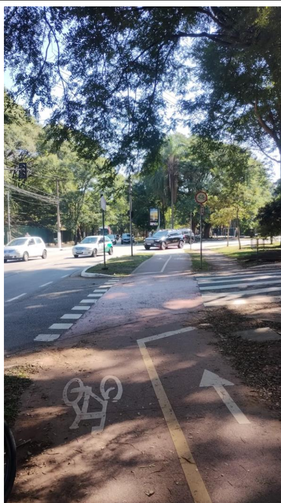
Foto 15 - Ciclovía Faria Lima: Falta de sinalização vertical e horizontal em cruzamento com via de automóveis.
