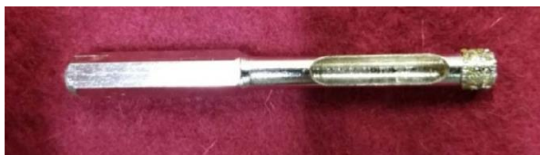
Fig. 2 - Instrumento de corte do tipo trefina, utilizado para cortar as amostras cônicas.
