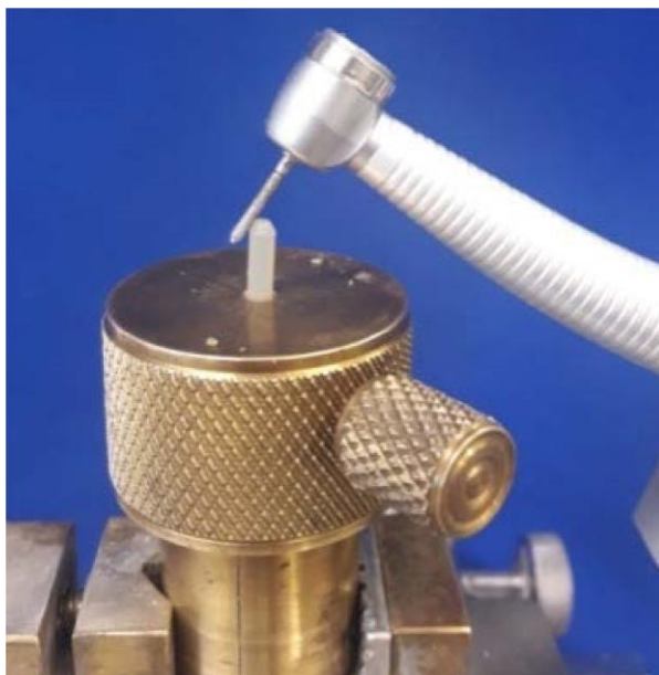
Fig. 3 - Posicionamento no Multi CP 2000 para confecção da ponta semelhante a uma cúspide.
