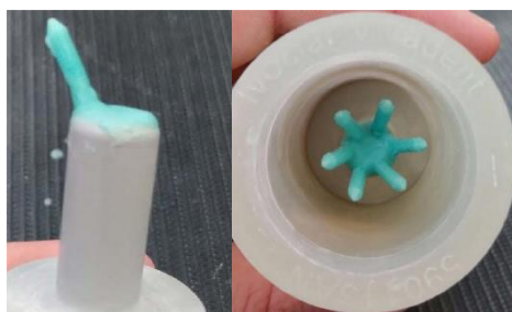
Fig. 5 – Amostras cilíndricas enceradas e posicionadas no anel de inclusão.
