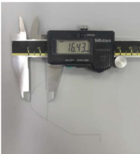
Fig. 11 – Paquímetro posicionado nos perfis para medir a perda de altura das amostras cônicas.
