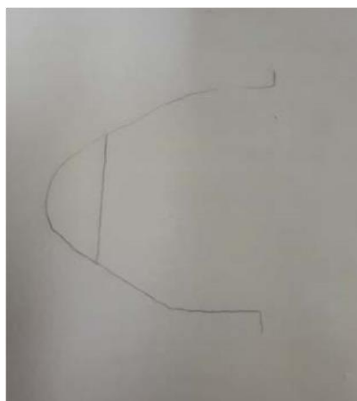
Fig. 9 – Traçado de perfil da amostra cônica em folha de papel vegetal.
