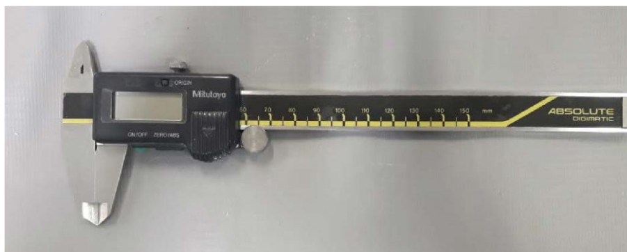
Fig. 10 – Paquímetro Mitutoyo utilizado para medir a altura de desgaste das amostras cônicas.
