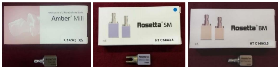
Fig. 1 - Materiais cerâmicos para CAD/CAM utilizados. A - Amber Mill (cerâmica de dissilicato de lítio); B - Rosetta SM (cerâmica de dissilicato de lítio); C - Rosetta BM (cerâmica feldspática com leucita).
