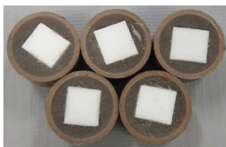
Fig. 7 – Amostras planas embutidas em anel de cano PVC e resina acrílica autopolimerizável.
