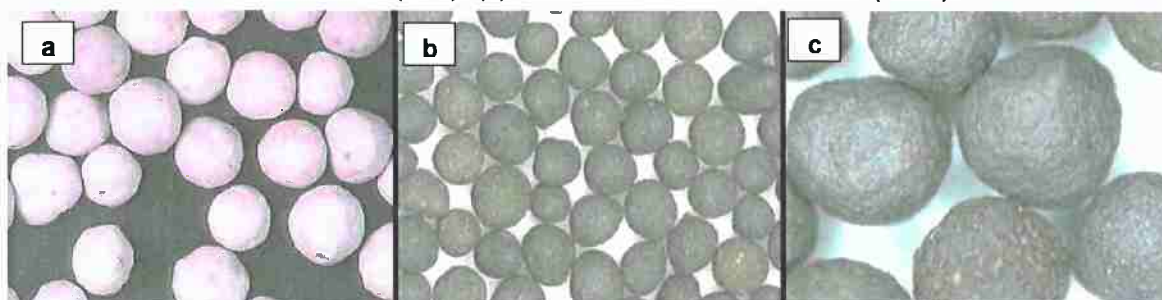
Figura 6. Cerâmicas propantes: (a) cerâmica leve (LWC), (b) cerâmica de densidade intermediária (IDC), (c) cerâmica de alta densidade (HDC).
