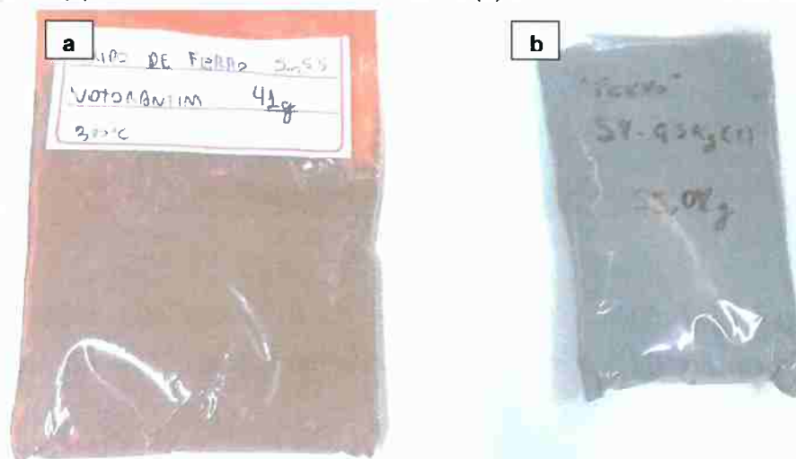
Figura 13. (a) óxido de ferro nanoestruturado e (b) óxido de ferro microestruturado.
