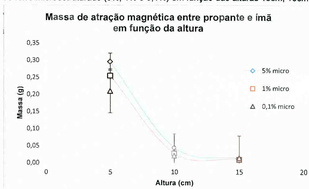
Gráfico 5. Gráfico da medida das massas medidas do propante recoberto com resina epóxi e óxido de ferro microestruturado (5%, 1% e 0,1%) em função das alturas 15cm, 10cm e 5cm.
