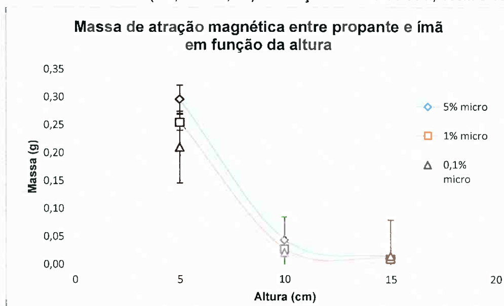
Gráfico 4. Gráfico da média das massas do propante recoberto com resina poliéster e óxido de ferro nanoestruturado (5%, 1% e 0,1%) em função das alturas 5cm, 10cm e 15cm.
