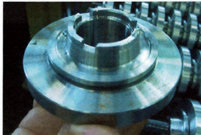
Figura 63 - Peça após processo de corte dos chanfros do sistema de sincronização
