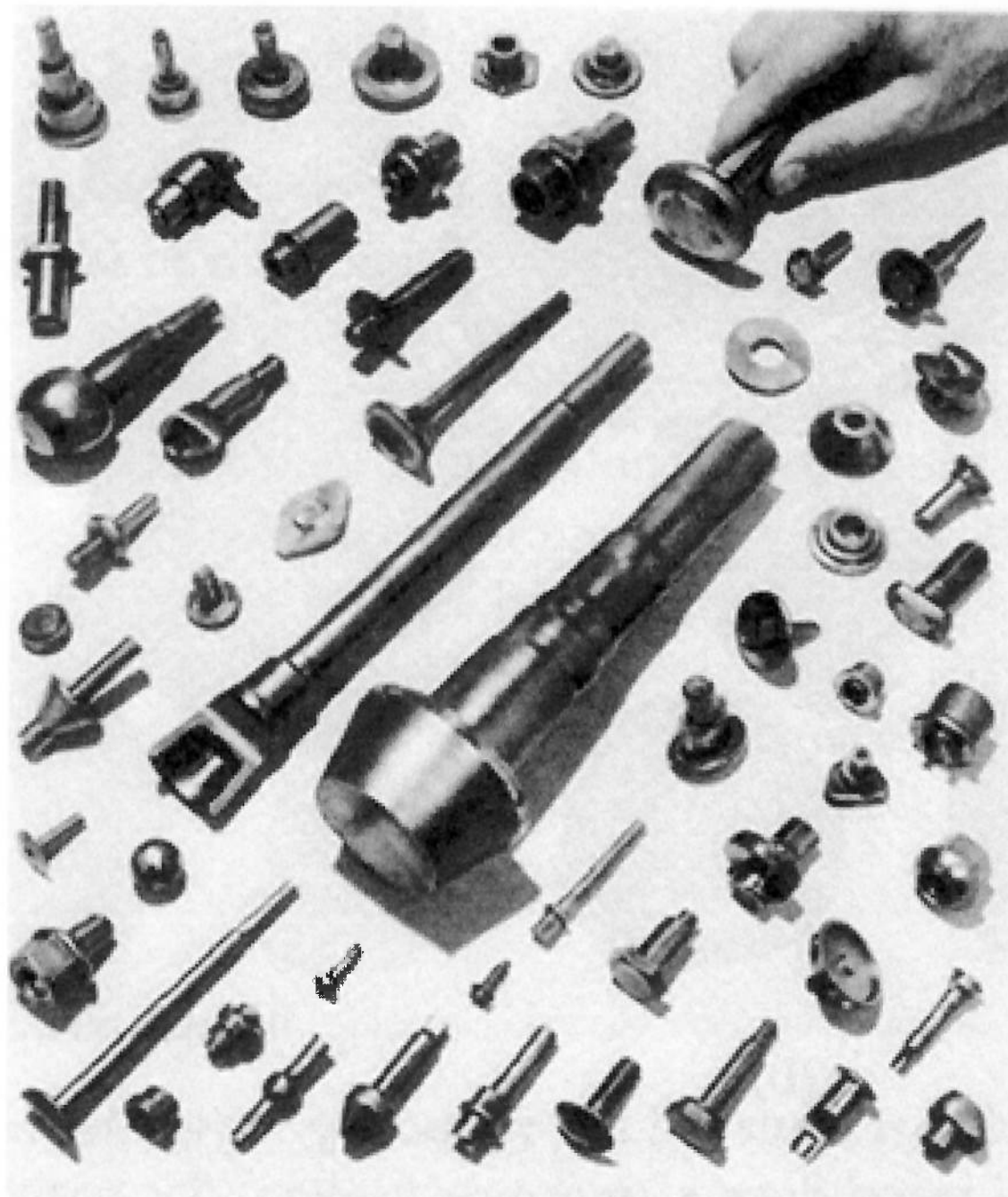
Figura 23 – Exemplo de forjamento por UPSET
