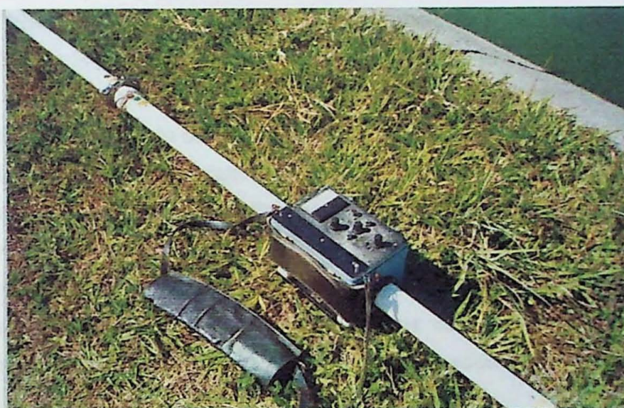
Foto 3- Equipamento EM-31, utilizado para obter os dados de Eletromagnetismo.
