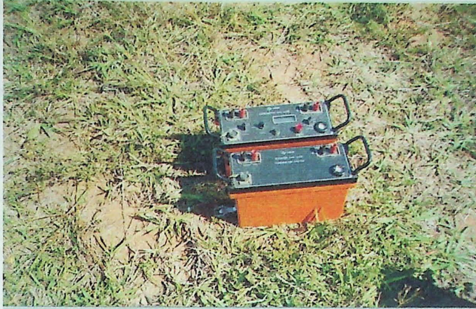
Foto 2- Equipamento SAS 300B, utilizado para obtenção dos dados de Resistividade.
