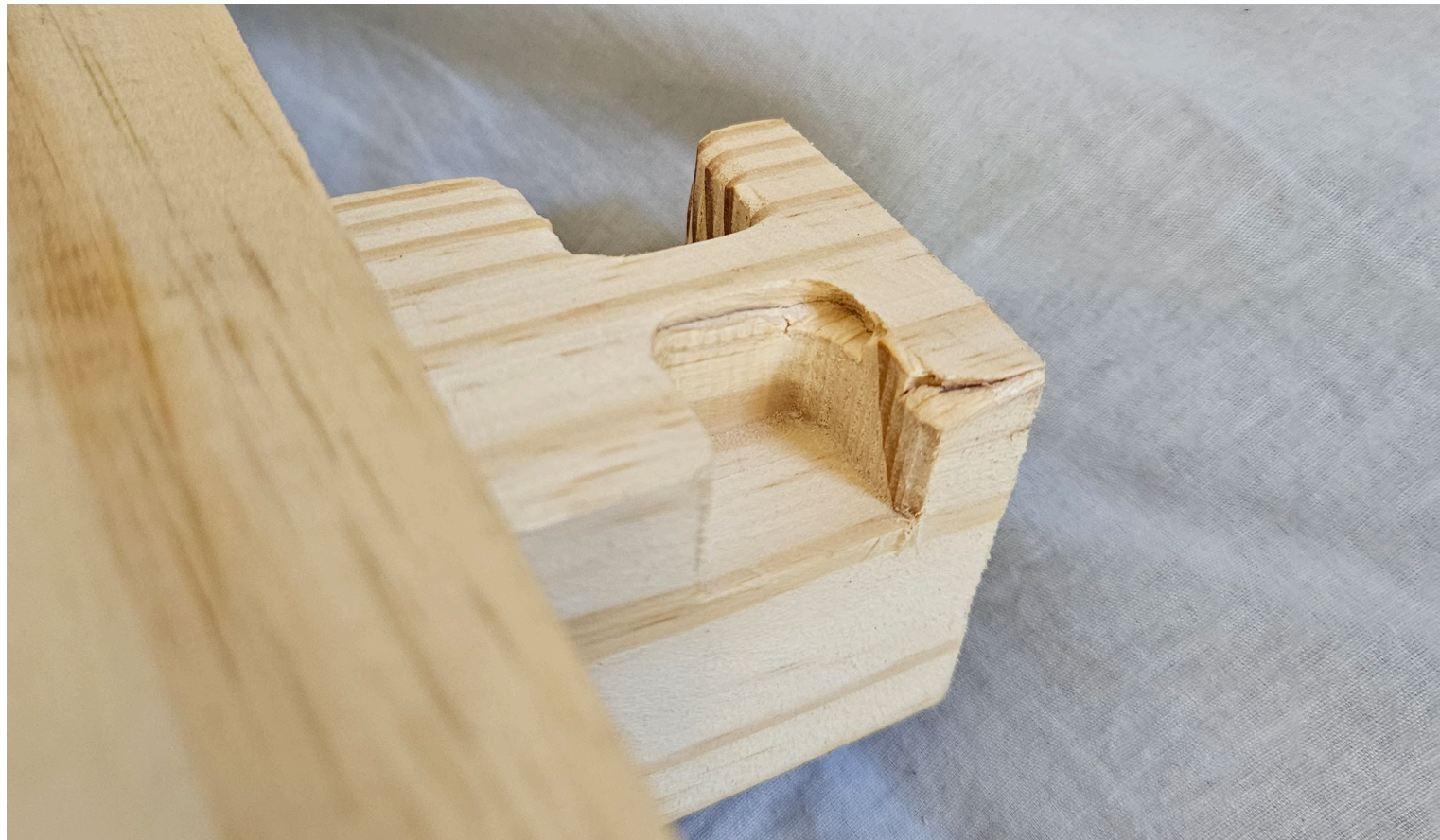
Figura 63 - Avaria na peça ao desencaixá-las
