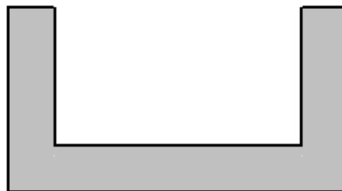
Figura 8-7 - Seção Transversal da viga calha
