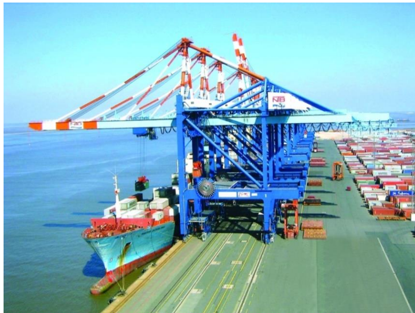
Figura 2-2 - Portêineres carregando navios
