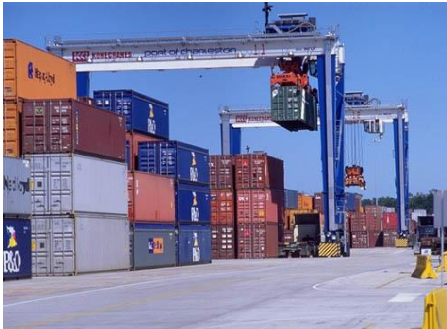
Figura 2-5 - Transtêiner descarregando contêiner de caminhão
