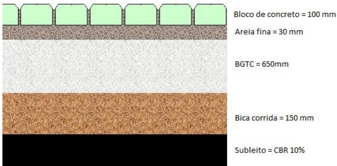
Figura 6-5 - Camadas do pavimento de blocos de concreto intertravados
