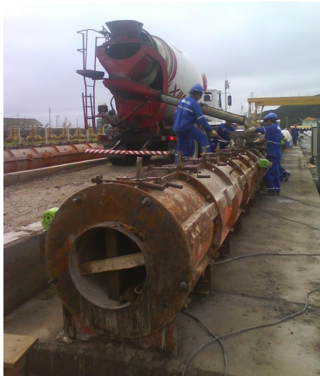
Figura 3-12 - Fôrma metálica interna e externa
