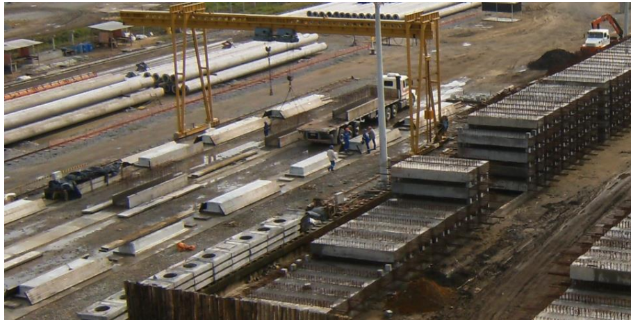
Figura 3-14 - Fôrmas e Estocagem da Laje \pi
