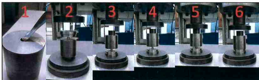
Figura 56: Processo de briquetagem das amostras na EMIC
