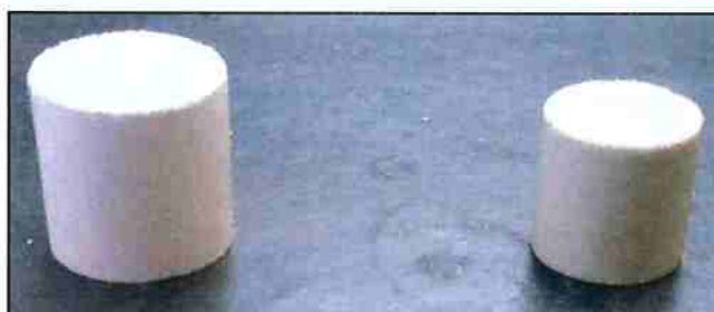
Figura 60: Comparação visual de tamanho entre um briquete não-sinterizado e um sinterizado. Amostra 5M–15 (à esquerda) e 5M–1 (à direita)
