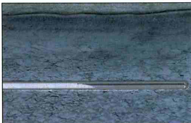
Figura 17: Cimento é bombeado pelo revestimento de aço [5]
