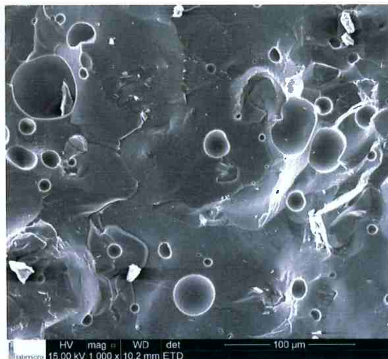
Figura 76: Micrografia da amostra 10M sinterizada a 1100°C com magnificação de 1000x
