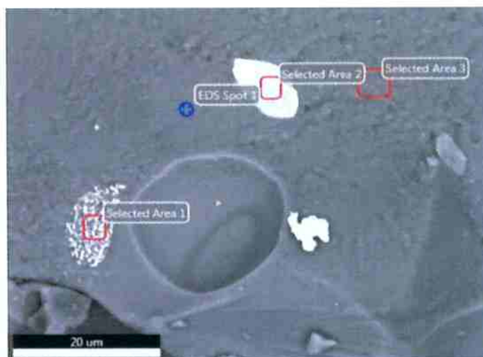
Figura 107: Micrografia da amostra 7,5M sinterizada a 1200°C mostrando inclusões com áreas selecionadas para análise quantitativa
