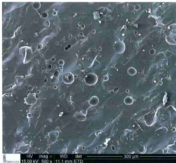
Figura 87: Micrografia da amostra 12,5M sinterizada a 1100°C com magnificação de 500x
