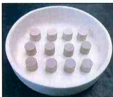
Figura 59: Briquetes colocados no cadinho de alumina para queima em forno
