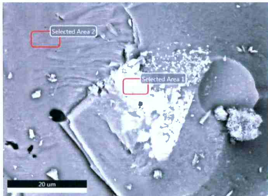
Figura 66: Micrografia da amostra 5M sinterizada a 1100°C mostrando uma inclusão com áreas selecionadas para análise quantitativa
