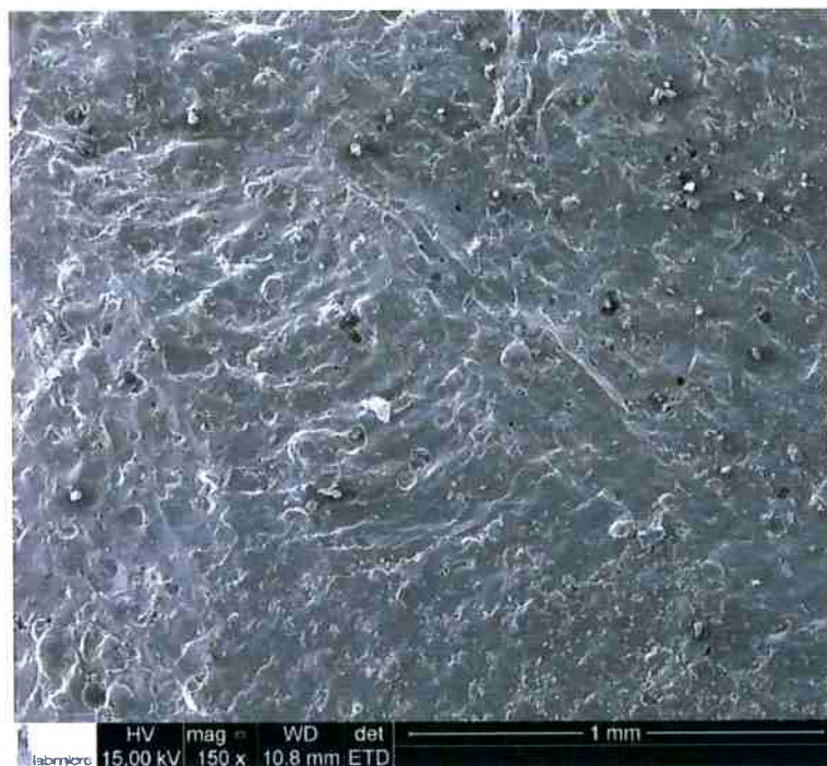
Figura 94: Micrografia da amostra 7,5M sinterizada a 1100°C com magnificação de 150x
