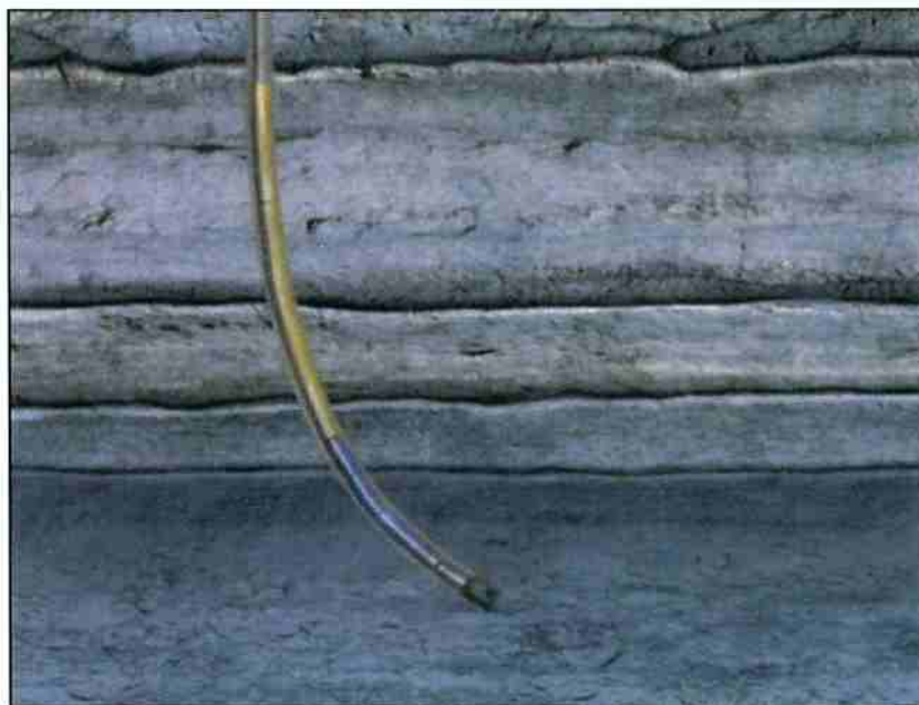
Figura 13: Motor MWD realizando a perfuração curva [5]
