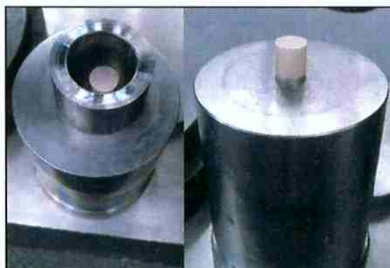
Figura 57: Briquetes cilíndricos produzidos pós-extração da matriz metálica
