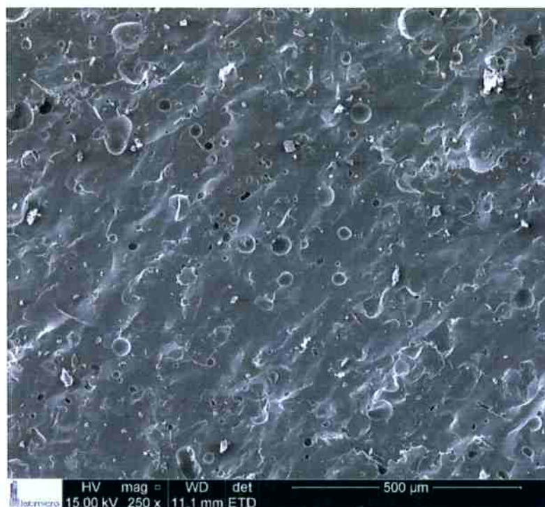
Figura 86: Micrografia da amostra 12,5M sinterizada a 1100°C com magnificação de 250x
