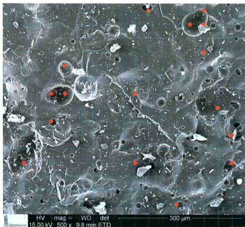
Figura 112: Análise da amostra 15M sinterizada a 1100°C mostrando a grade feita de 3cm 2 por ponto (em azul) e os pontos de coincidência com poros.
