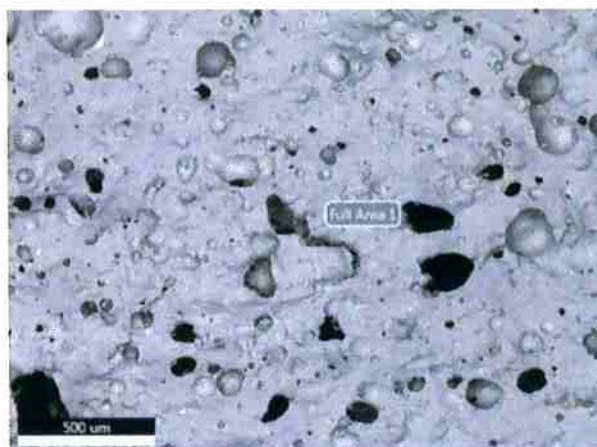
Figura 105: Micrografia de uma grande área da amostra 7,5M sinterizada a 1200°C para análise da composição química do material como um todo
