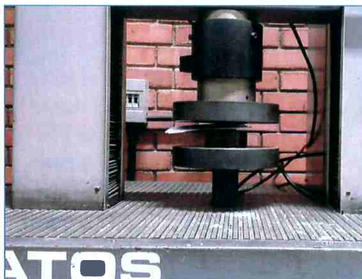
Figura 63: Montagem do ensaio na Kratos. A amostra é comprimida pela célula de carga até o colapso total
