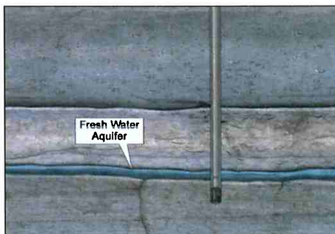
Figura 7: Passagem pela profundidade das reservas aquíferas [5]
