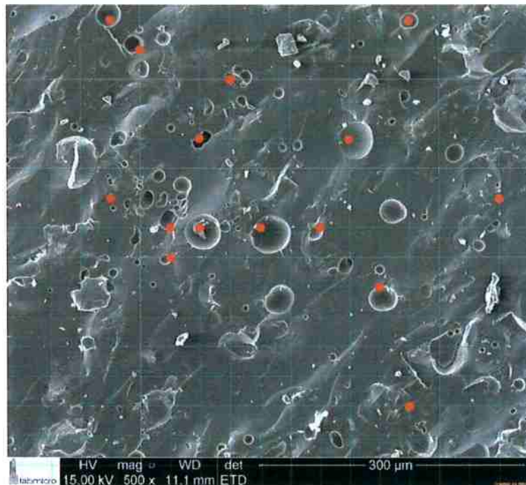
Figura 114: Análise da amostra 12,5M sinterizada a 1100°C mostrando a grade feita de 3cm 2 por ponto (em azul) e os pontos de coincidência com poros
