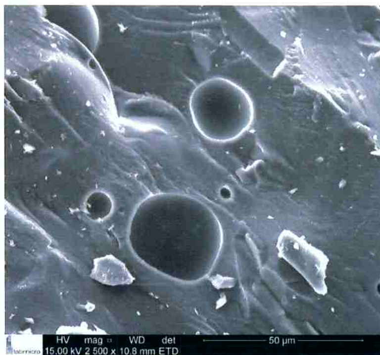
Figura 96: Micrografia da amostra 7,5M sinterizada a 1100°C com magnificação de 2500x onde se pode ver a presença de poros fechados
