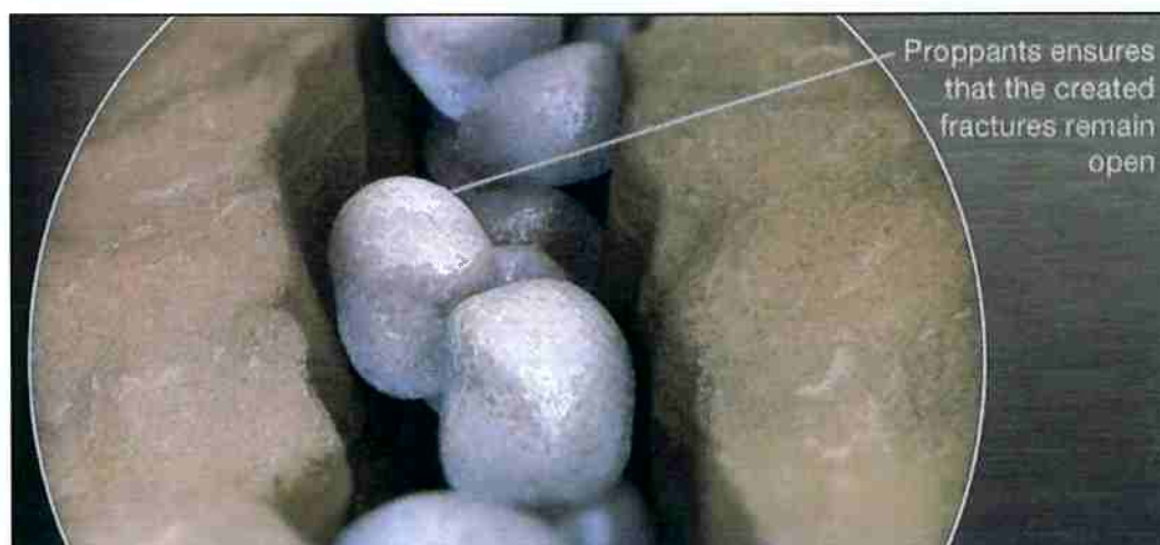
Figura 3: Propantes nas trincas causadas por fraturamento hidráulico [1]
