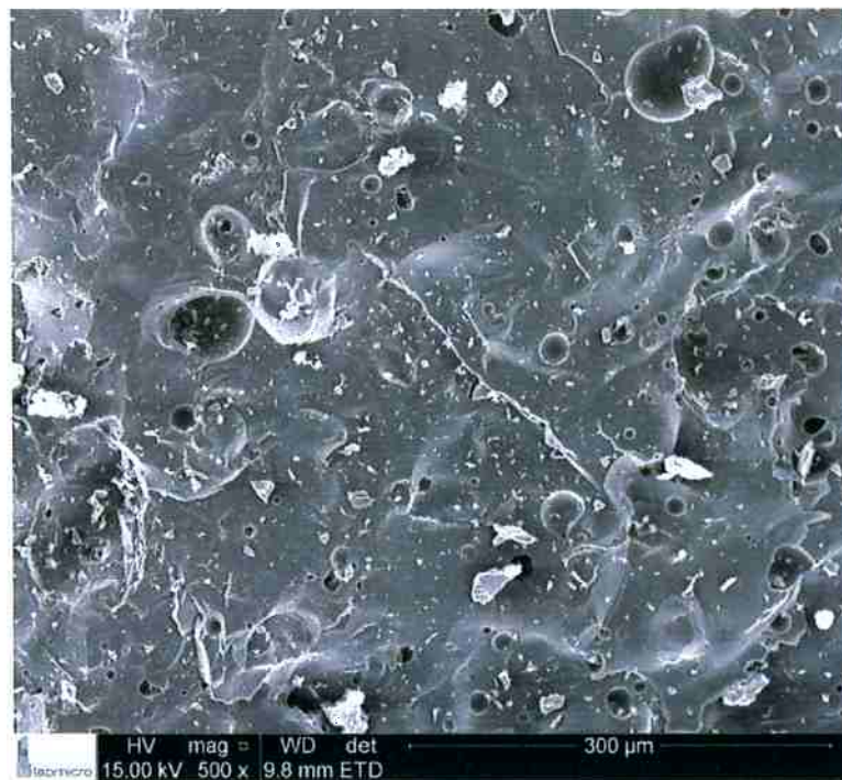
Figura 65: Micrografia da amostra 5M sinterizada a 1100°C com magnificação de 500x
