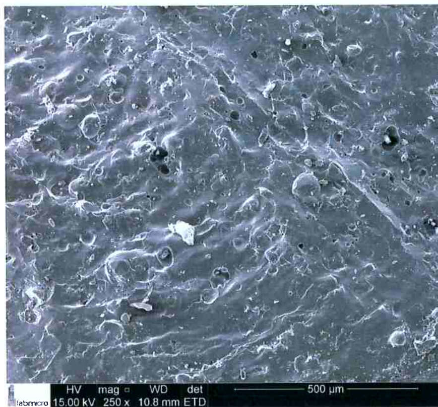
Figura 95: Micrografia da amostra 7,5M sinterizada a 1100°C com magnificação de 250x
