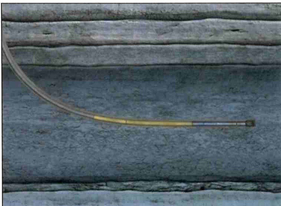
Figura 14: Perfuração horizontal do poço [5]
