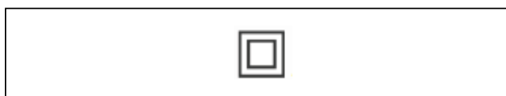
Figura 05 – Símbolo de isolação dupla ou reforçada.
