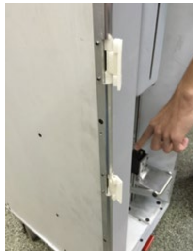
Figura 98. pedal do amassador de latas. Fonte: autor
