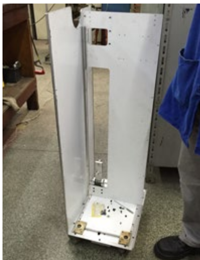
Figura 97. estrutura em ACM com rodízios. Fonte: autor
