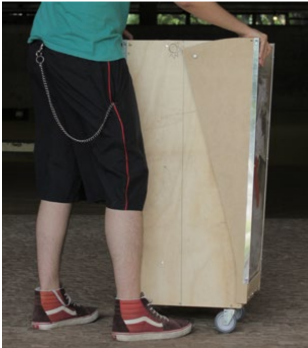
Figura 32. modelo de madeira ao ser compactado manualmente. Fonte: grupo Retrolley
