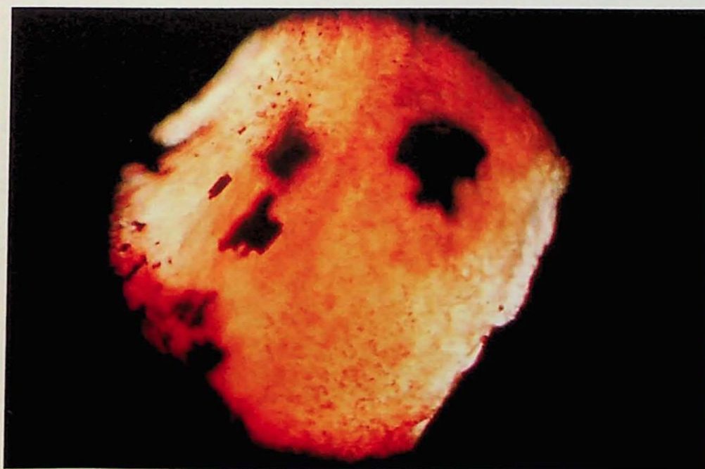
FOTO 2: grão misto avermelhado (opacos + carbonatos + apatita). Amostra P1281 de produto flutuado, fração 48, nicóis cruzados e objetiva 10x.
