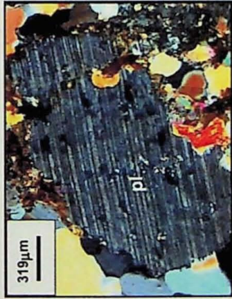
Foto 29: Rocha pouco alterada com plagioclásio (pl) em início de dissolução.
