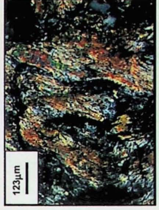
Foto 35: Isalterita com biotita com as bordas sendo caolinitizadas.
