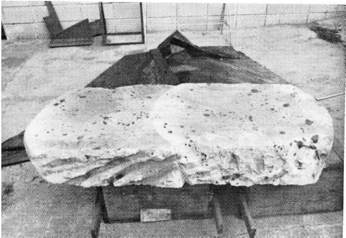
Figura 9 - Adesão entre colunas de jet-grouting .
