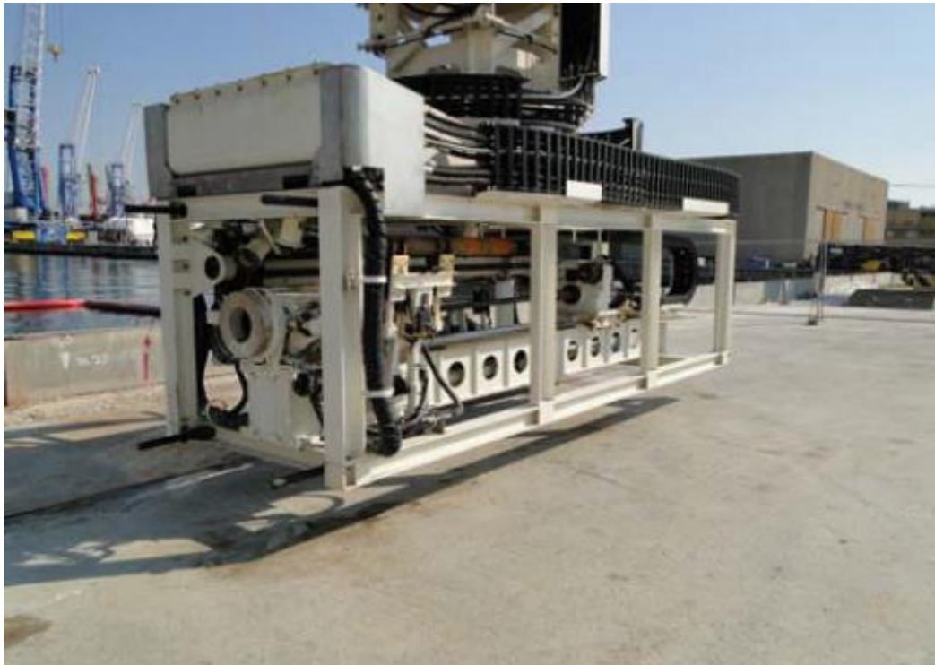
Figura 28 - Célula perfuratriz utilizada para realizar os tirantes submersos de jet-grouting armado de prova.
