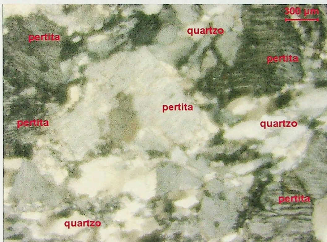
Lâmina GAP-2003-3: banda mais feldspática formada por cristais de feldspato alcalino fortemente perítico em matriz quartzosa inequigranular cominuída. Nicóis cruzados. Aumento de 10x.
