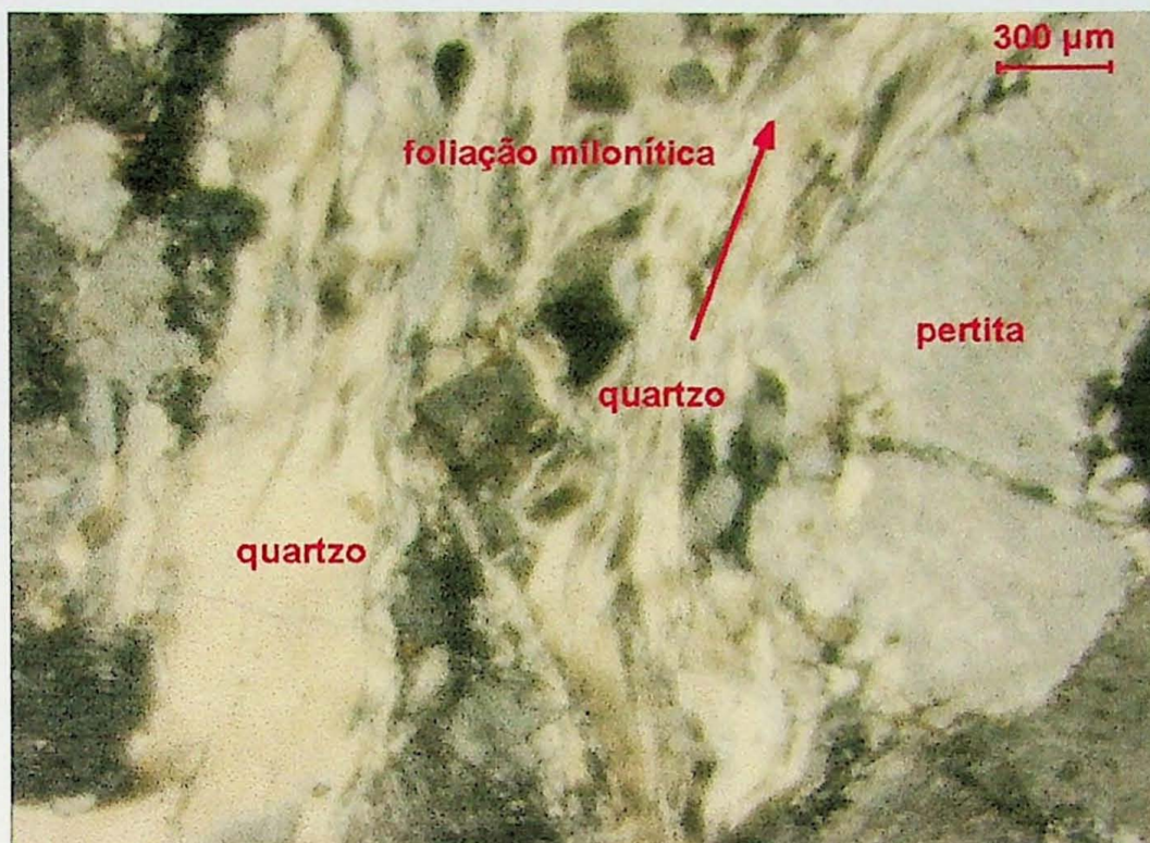
Lâmina GAP-2003-6: Banda formada por quartzo recristalizado orientado segundo a foliação milonítica. À direita: porfiroclasto de feldspato alcalino peritítico. Nicóis cruzados. Aumento de 10x.
