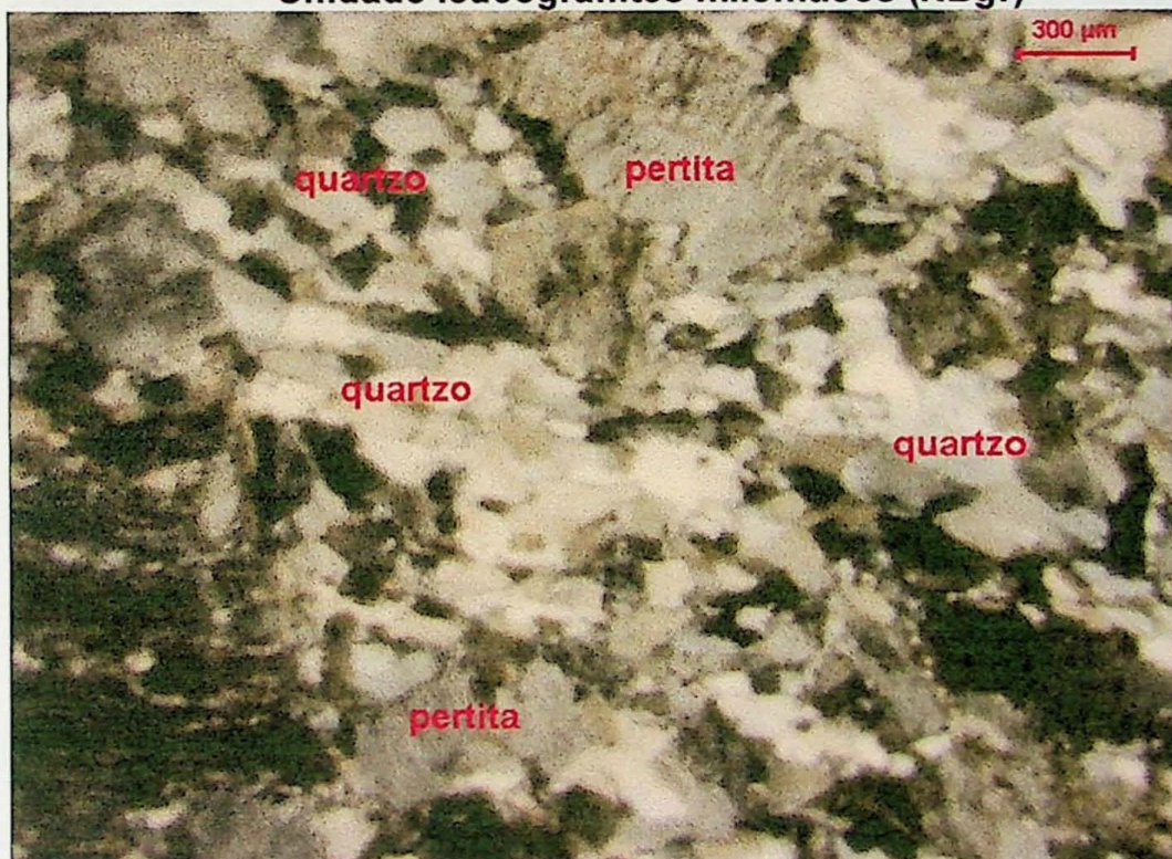
Lâmina GAP-VII-80: Textura porfiroclástica formada por porfiroclastos de feldspato alcalino perítico em matriz quartzosa cominuída, recristalizada e orientada segundo a foliação milonítica. Nicóis cruzados. Aumento de 10x.
