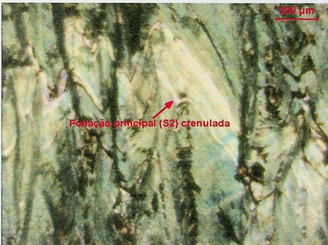
Lâmina GAP-00-58B: plano de foliação principal S2, formado predominantemente por sericita, com crenulações que formam a superfície S3. Nicois cruzados. Aumento de 5x.
