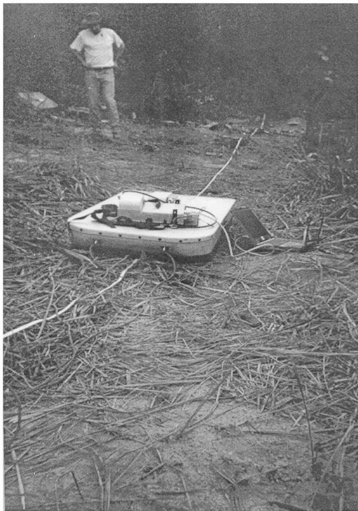
Foto 2 – Antena blindada de 100 MHz
