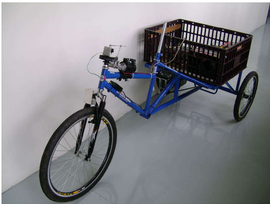
Figura 45 - Triciclo desenvolvido para testes do sistema de comando da embarcação.
