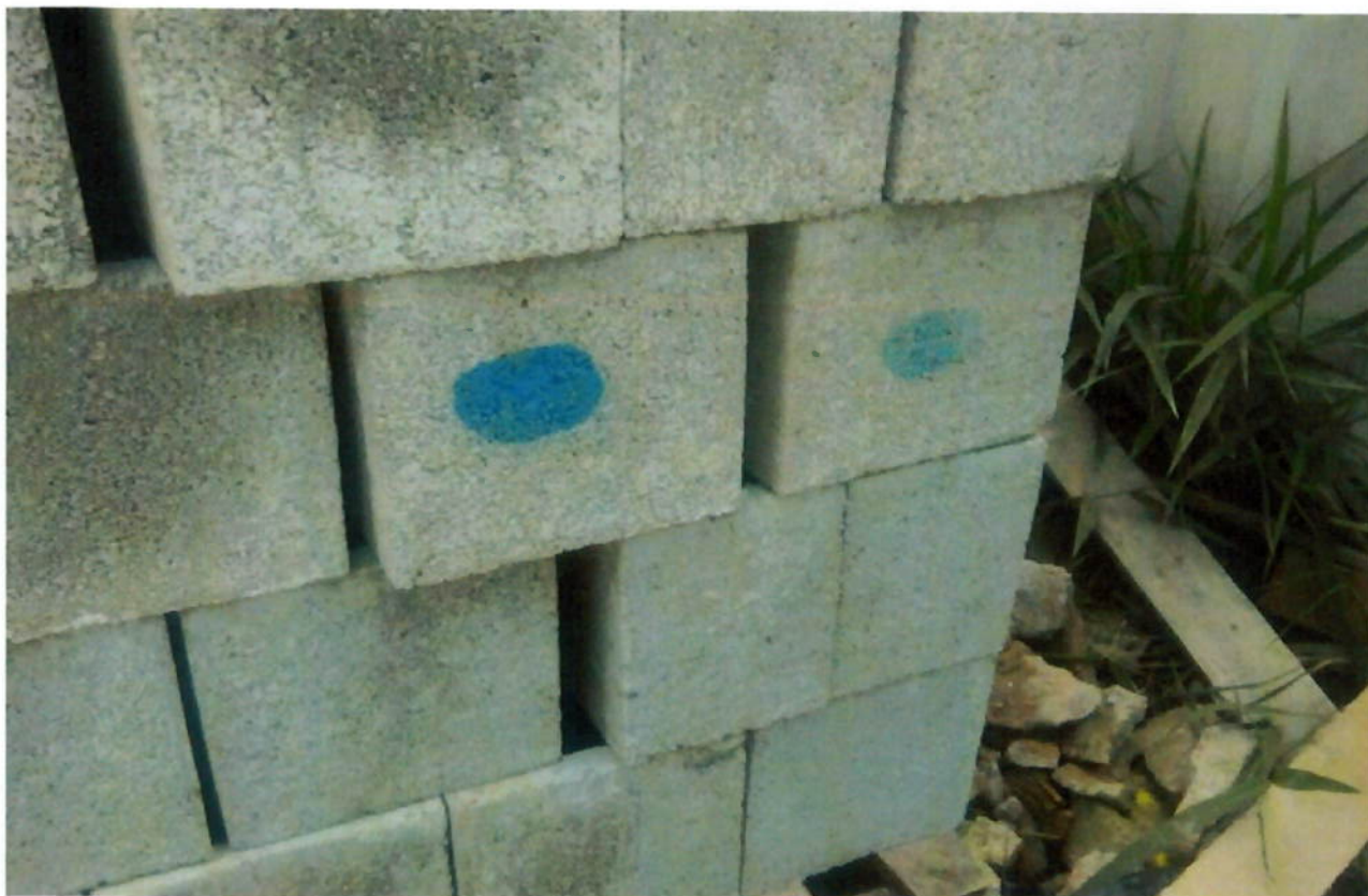
Figura 65 - Foto de estoque de bloco em obra – identificação com tinta “látex” (fevereiro / 2011- fonte: Arquivo Schahin)
