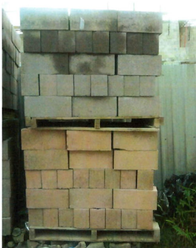
Figura 86 – Paletes de blocos coloridos estocados em canteiro de obra (fonte: arquivo Schahin)
