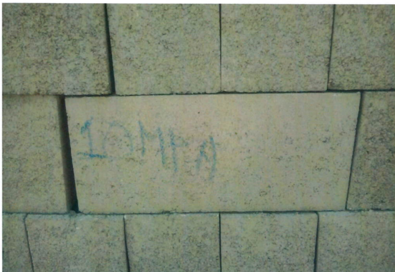
Figura 67 - Foto de estoque de bloco em obra – identificação com giz de cera (fevereiro / 2011- fonte: Arquivo Schahin)
