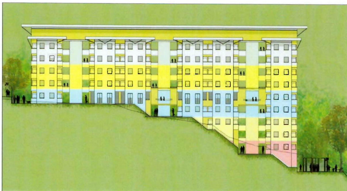
Figura 19 - Elevação do Edifício 4 mostrando em diferentes cores as resistências específicas dos blocos de concreto estruturais que compõem cada pavimento, iniciando com 12,0 MPa no 3.º pavimento inferior (cor rosa) e terminando com 4,0 MPa no 3.º pavimento superior (cor cinza). O pavimento "térreo" (na cor azul) é o piso que interliga todos os prédios através de corredor único, permitindo assim acesso que evita a utilização de elevadores (fonte original: José Tabith Arquitetos Associados - Arte sobre a fonte original para identificação das resistências características dos blocos: Azul Publicidade).
