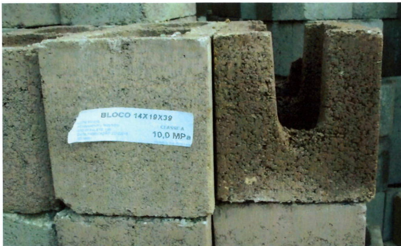
Figura 68 - Foto de estoque de bloco em obra – identificação com etiqueta adesiva (fevereiro / 2011- fonte: Arquivo Schahin)
