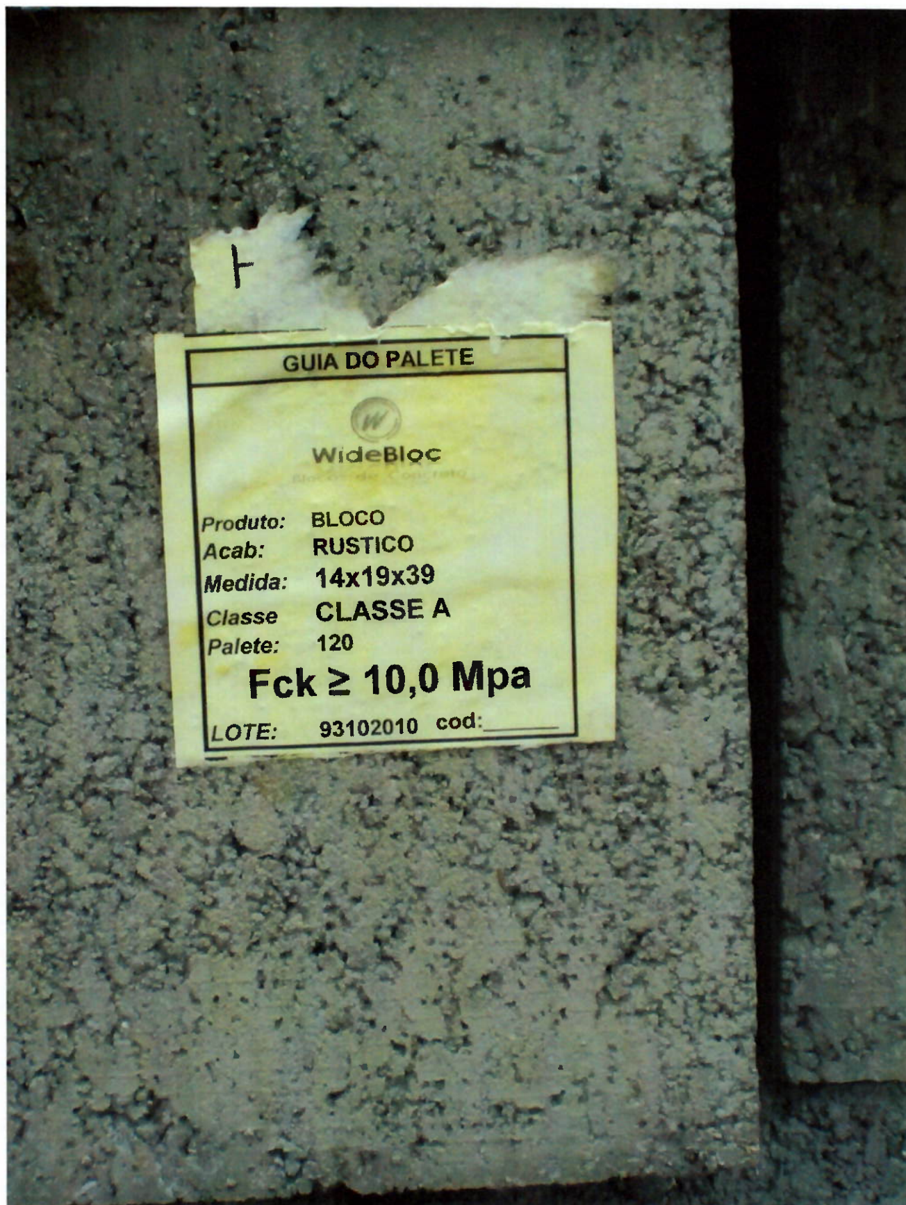
Figura 69 - Foto de estoque de bloco em obra – identificação com etiqueta adesiva (fevereiro / 2011- fonte: Arquivo Schahin)
