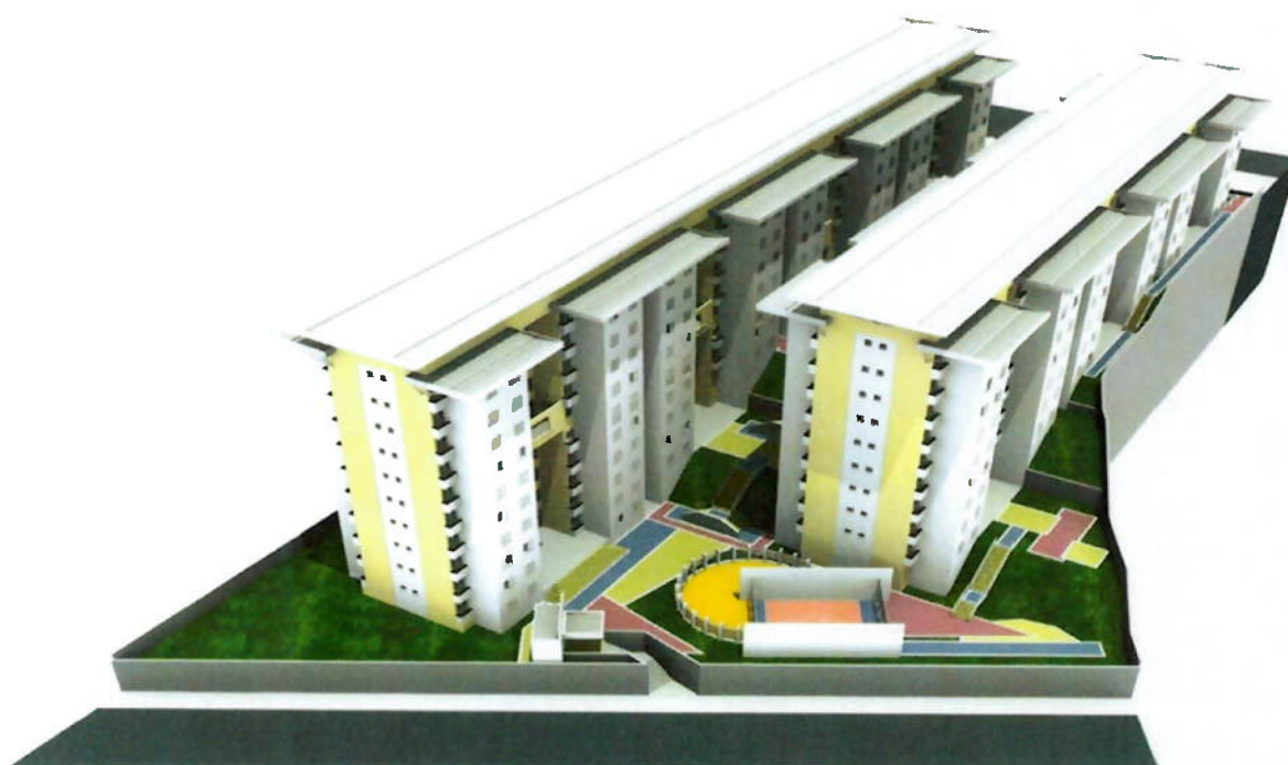
Figura 17 - Perspectiva Aérea da Fig.14 mostrando o interior do conjunto e as coberturas metálicas dos Edifícios 04 e 05 (da direita para a esquerda): o conceito de "coberturas sombreantes" aplicado pelos idealizadores do projeto, permite uma maior durabilidade das fachadas, protegendo-as da ação das intempéries por mais tempo. (fonte: José Tabith Arquitetos Associados).
