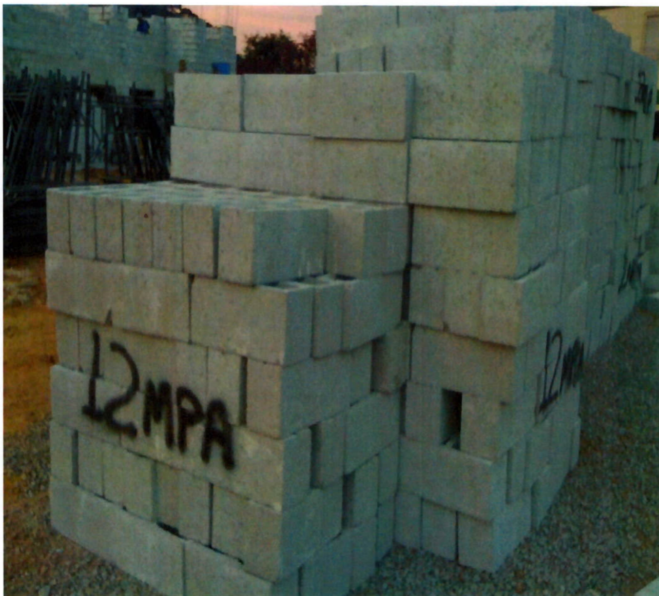
Figura 57 - Foto de estoque de bloco em obra – identificação com tinta “ spray ” (fonte: Eng. José Carlos de S. Leme Jr.)
