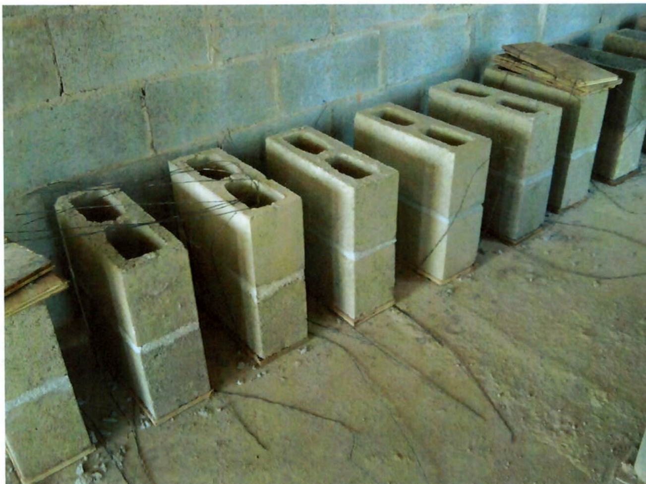
Figura 73 - Prismas Simples moldados na obra Mata Virgem (fonte: arquivo Schahin).
