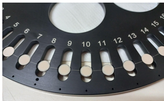
FIG. 8. Alíquotas preparadas das amostras poliminerálicas do CDH-79 encaixadas no carrossel do leitor de luminescência Risø TL/LOE DA-20.
