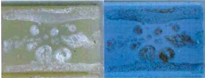
Figura 114 - Morfologia da poça de fusão da amostra com 6% de nanosílica para um tempo de soldagem de 0,3s.
