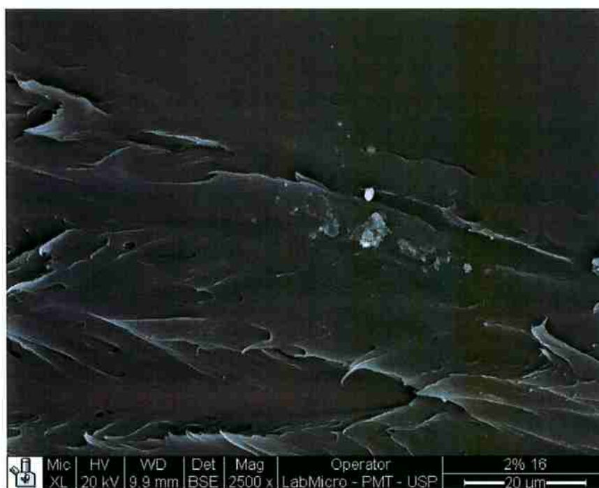
Figura 105 - Imagem obtida por MEV (SE) com resolução de 20 \mu\text{m} . Observa-se a borda de uma das poças de fusão internas da Figura 104, amostra 2%-16, com 1% de carga. Amostra cisalhada, par de soldagem com a amostra 2%-15, com tempo de soldagem igual a 0,4 segundos.
