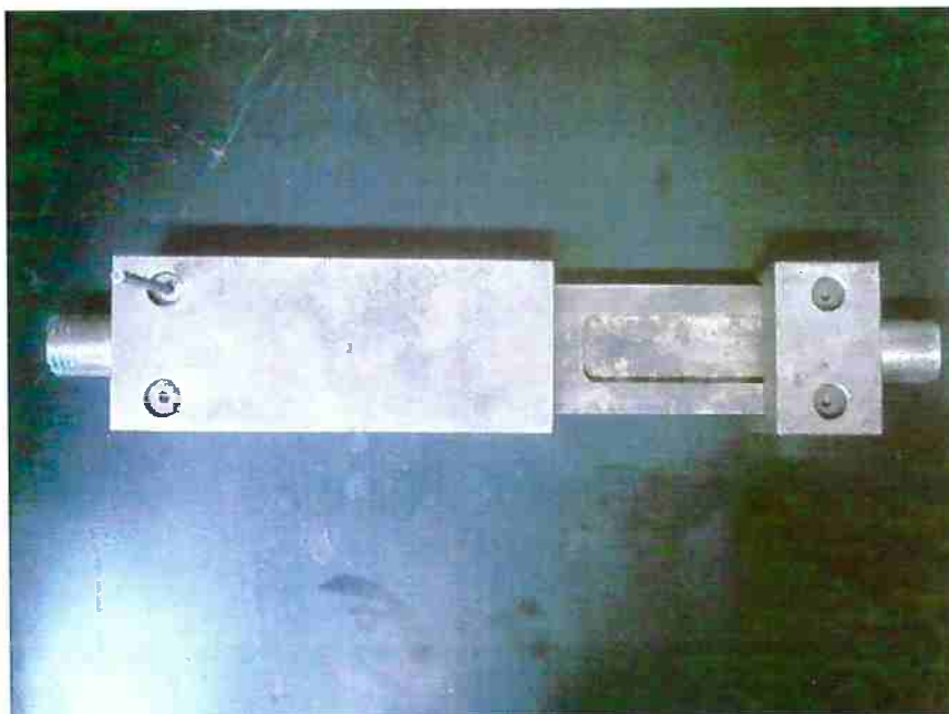
Figura 18 - Dispositivo utilizado para cisalhamento dos CPs soldados.
