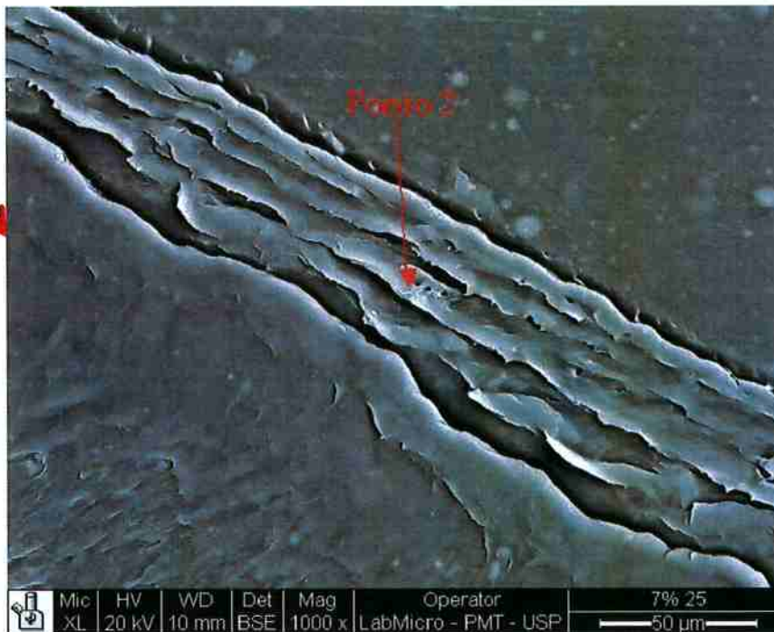
Figura 112 - Imagem obtida por MEV (BSE) com resolução de 50 µm. Amostra 7%-25, com 6% de carga, par de soldagem com a amostra 7%-26, cisalhada. Bordas da Figura 111. Observa-se que existe concentração de nanosilica no Ponto 2 (ver espectroscopia de Raios X na Figura 113), porém não é possível observar aglomerados. As partículas devem estar bem homogeneizadas nestas ondas de ataque - bordas.
