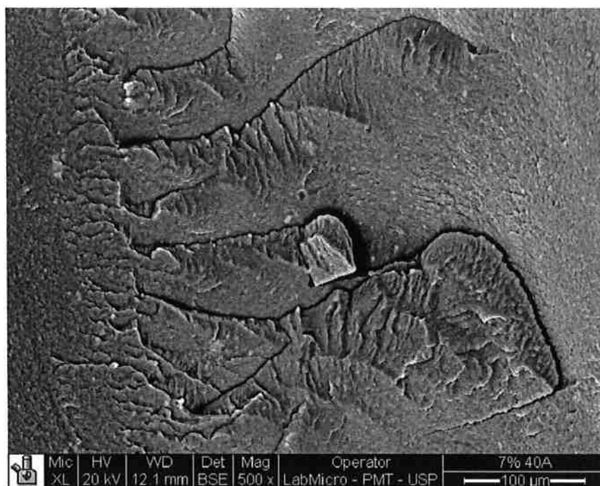
Figura 84 - Imagem obtida por MEV (BSE) com resolução de 100 µm, com ênfase no aglomerado de Si. Fratura criogênica da amostra 7%-40, com 6% de carga.
