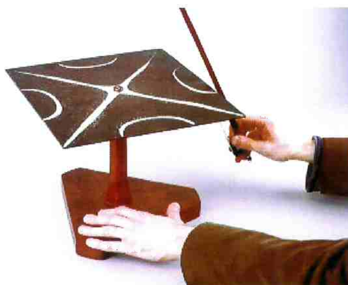
Figura 12 – Ilustração do experimento de Chladini: placa de metal quadrada, apoiada sobre um suporte, afixada por um parafuso central, excitada com um arco de violino. A indução dos modos pode ser realizada com o dedo indicador, ou seja, com o dedo amortecese a vibração em pontos adequados. [27]
