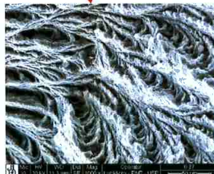
Figura 88 - Imagem obtida por MEV (SE) com resolução de 50 \mu\text{m} . Fratura por ensaio de tração da amostra 0%-37, com 0% de carga de nanosilica. Observa-se a superfície da parte que sofreu fratura frágil.
