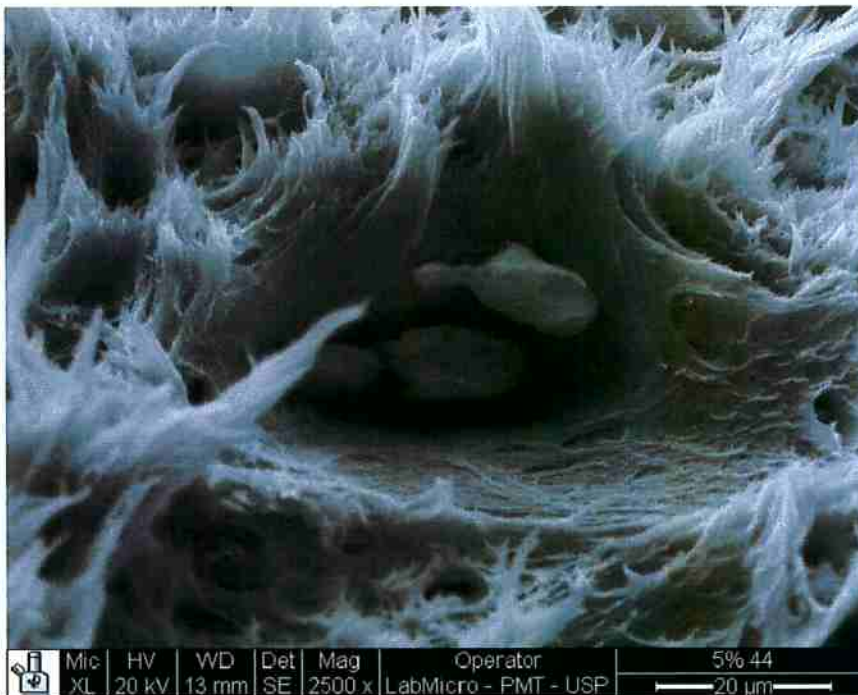
Figura 96 - Imagem obtida por MEV (SE) com resolução de 200 \mu\text{m} , da amostra 5%-44, com 5% de nanosílica. Apresenta a partícula aglomerada de nanosílica.
