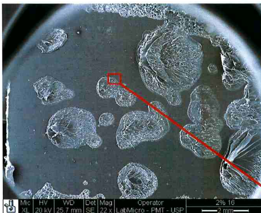
Figura 104 - Imagem obtida por MEV (SE) com resolução de 2 mm. Observa-se o aspecto geral da amostra 2%-16, com 1% de carga. Amostra cisalhada, par de soldagem com a amostra 2%-15, com tempo de soldagem igual a 0,4 segundos. Observa-se a formação de pequenas poças de fusão no interior da peça.
