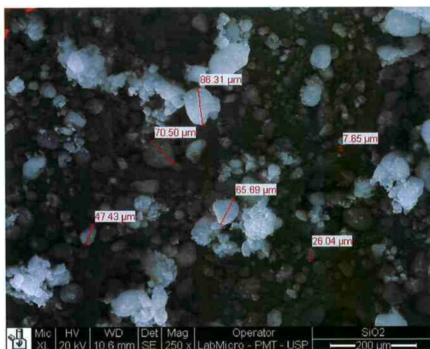
Figura 74 – Imagem obtida por MEV (SE) com resolução em 200 μm. Observação e medição do tamanho dos aglomerados de nanosilica higroscópica.
