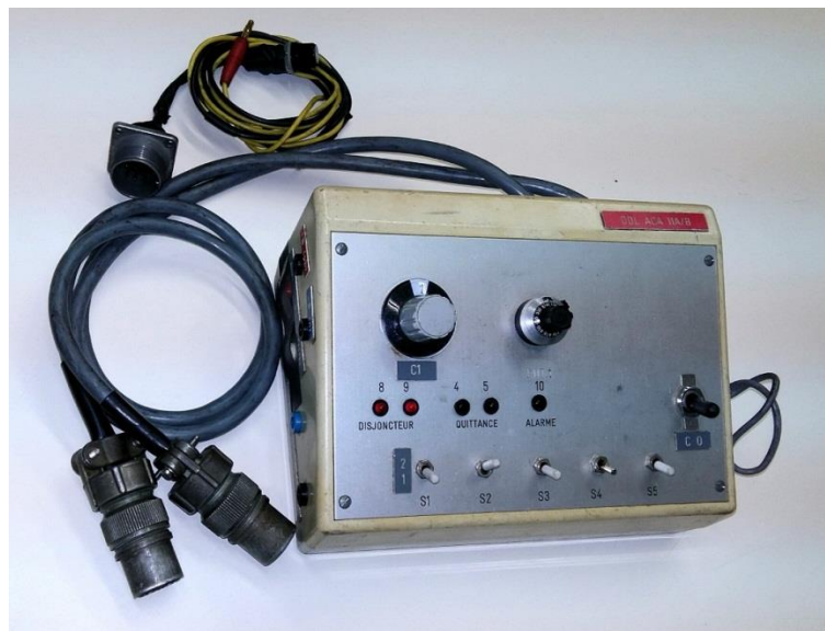
Figura 10 - Módulo Testador do relé DDL.
