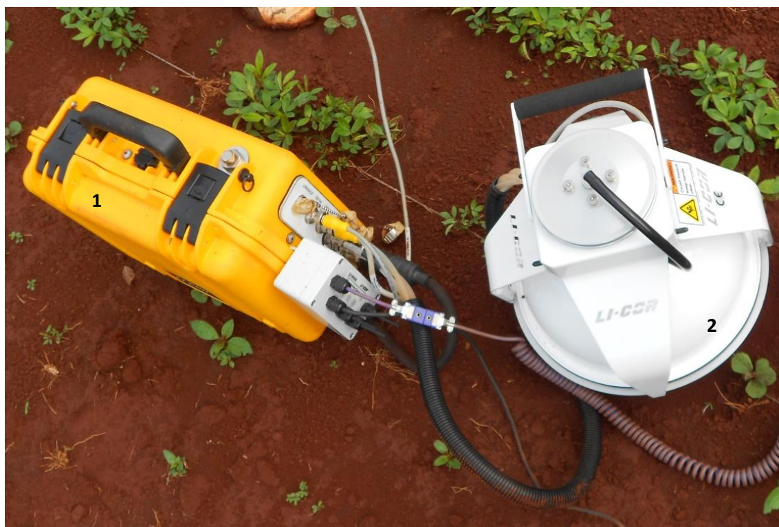
Figura 5. Sistema automatizado medidor de fluxo de CO 2 do solo, modelo LI-8100A (LI-COR, USA) utilizado neste estudo. (1) Unidade de controle com IRGA; (2) Câmara de medição.
