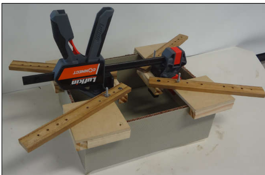
Figura 39 - Prensa de madeira pressionada por grampo de aperto rápido em uma gaveta de HoneyComb
