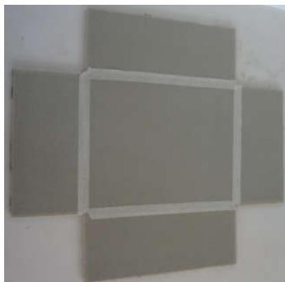
Figura 21 - Placas HoneyComb unidas com fita crepe para auxiliar a montagem
