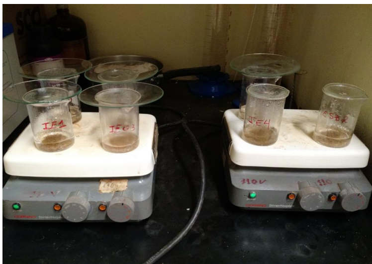
Figura 8 - Extração sequencial – etapa 3 (aquecimento da mistura sedimento/solução em chapa aquecedora).
