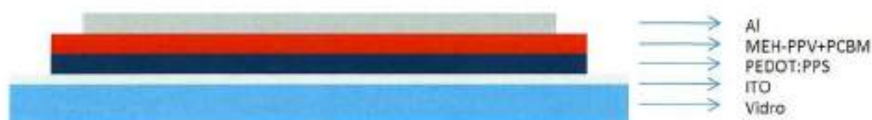
Fig. 8 – Modelo de célula orgânica de heterojunção.
