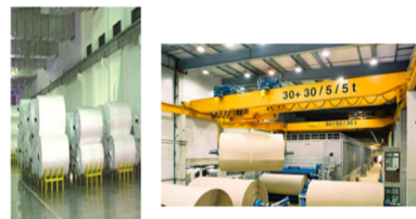
Figura 32- Alternativas para armazenamento de rolos
