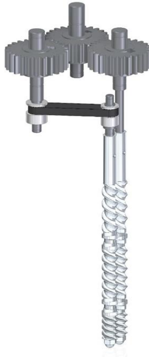
Figura 19 - Mecanismo de transmissão para dupla rosca corrotativa, com trem de engrenagens simples no primeiro estágio e transmissão por correia no segundo estágio. Fonte: Próprio autor
