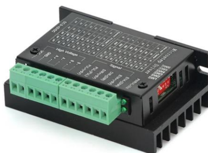
Figura 15 - Driver TB6600. Fonte: Disponível em: https://www.impactocnc.com/Driver-Motor-de-Passo-4A-TB6600 . Acessado em 29/12/2022
