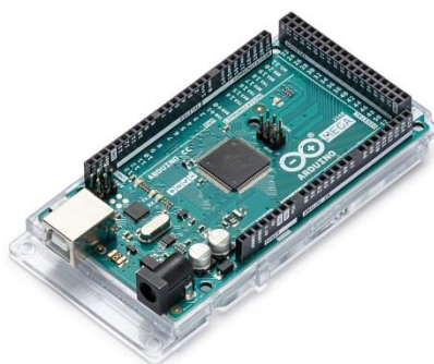
Figura 12 – Arduino Mega. Fonte: Disponível em: https://store-usa.arduino.cc/products/arduino-mega-2560-rev3?selectedStore=us . Acessado em 29/12/2022
