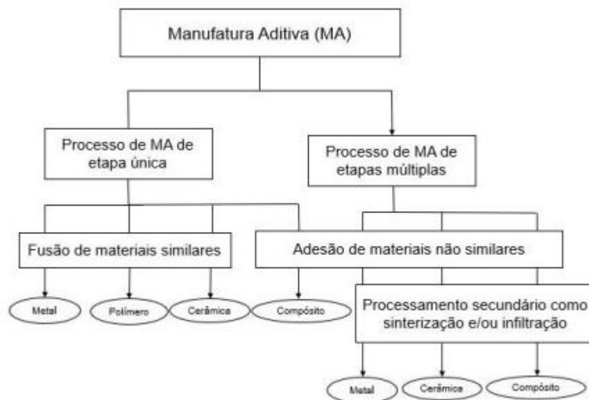
Figura 2 - Princípios de técnicas aditivas: passo único e passos múltiplos para materialização do objeto. Fonte: Traduzido de (ISO/ASTM52921, 2019).
