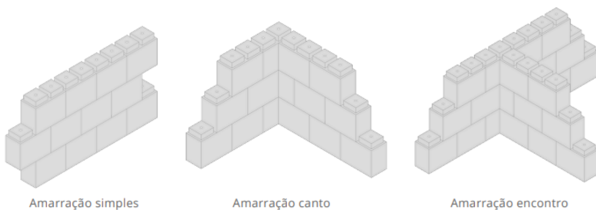
Figura 30: Encaixe entre os blocos de amarração.
