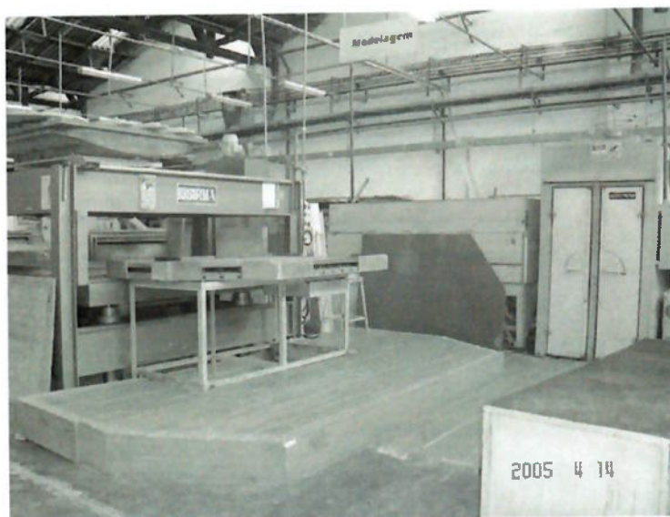
Foto 7: Acrílico - área de prensagem e de amolecimento de chapas acrílicas
