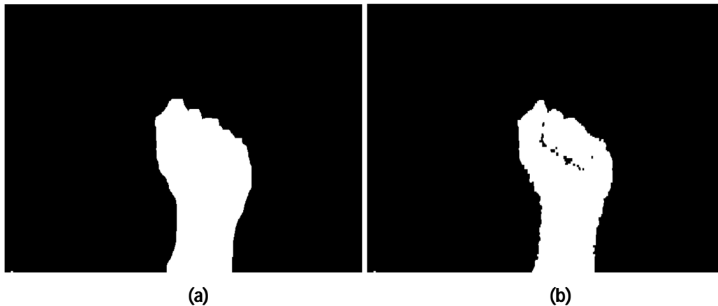
Figura 31 – Exemplo de Segmentação Manual (a) e pelo Algoritmo proposto (b)
