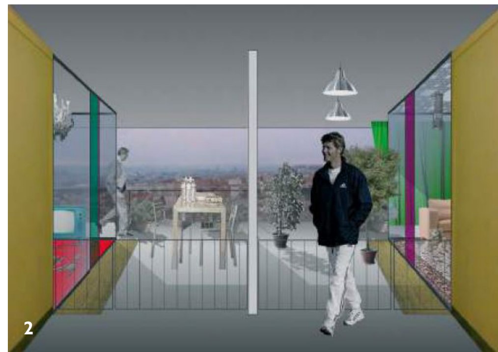
Imagens 1 e 2. Colagens representativas de exemplos de estratégias de integração e continuidade entre áreas internas e externas: conversão de vedos em partições transparentes entre o corredor e a unidade; e abertura do patamar para a área externa. Fonte: Plus - Large scale housing developments: An exceptional case , 2007.
