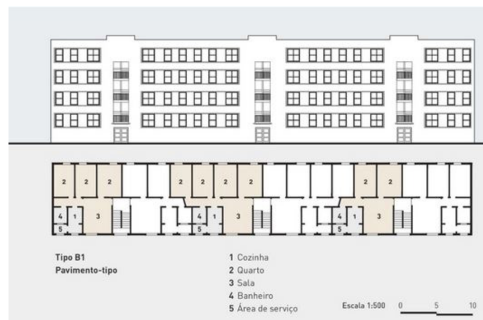
ELEVAÇÕES E PLANTAS DOS BLOCOS DE 4 PAVIMENTOS
