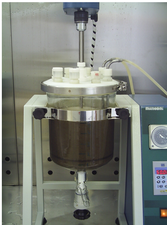
Figura 4.1 – Reator anóxico operado em bateladas seqüenciais com biomassa granulada
