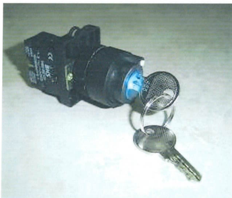
Figura 16 – Chave seletora utilizada no protótipo (Fonte: arquivo pessoal)
