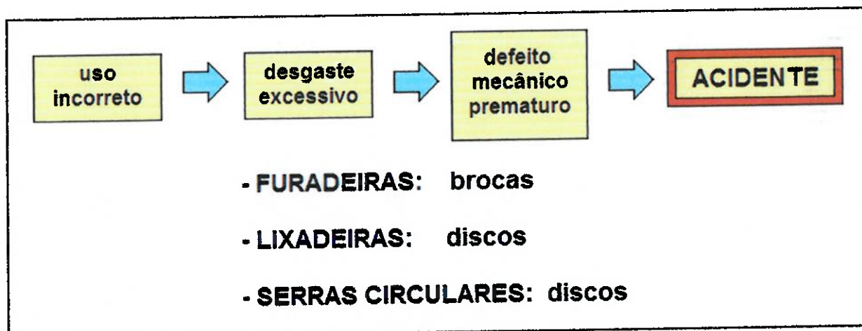
Figura 3 –Acidente a partir do mau uso de equipamentos (Fonte: arquivo pessoal)
