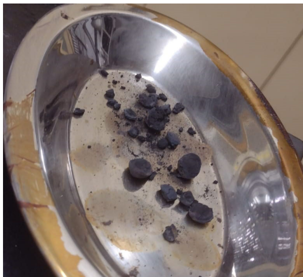
Figura 3.1: Aparência das pelotas da amostra S-1 após redução no forno, elaborado pelo autor.
