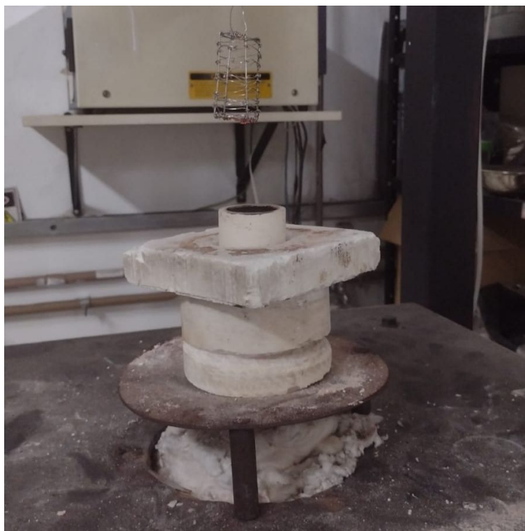
Figura 2.7: Suporte sobre entrada do forno, utilizada para inserção das amostras, elaborado pelo autor
