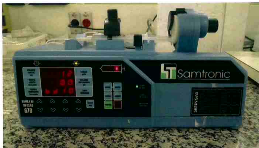
Figura 4.2 – Bomba de infusão Samtronic modelo 670 utilizada para controlar a taxa de infusão de solução polimérica durante o processo de eletrofiação.
