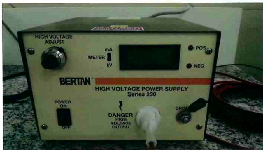
Figura 4.1 – Fonte de alta tensão Bertan série 230 utilizada no processo de eletrofiação.
