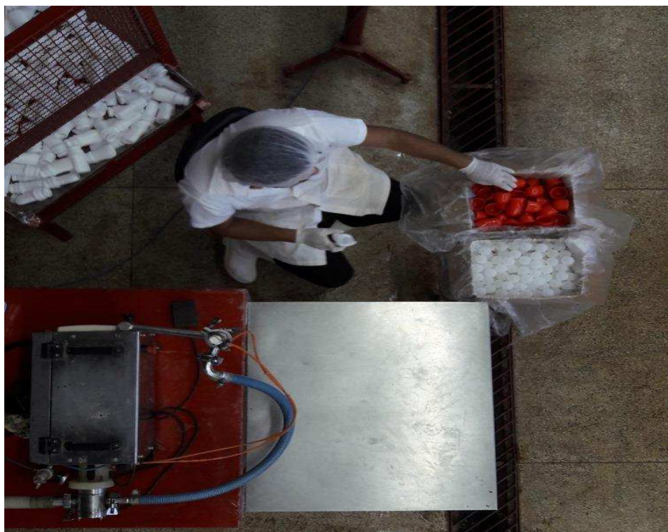
Figura 17 – Etapa de encaixe das bolinhas e fechamento com as tampas
