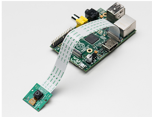
Figura 2.2: Raspberry Pi modelo B e módulo da câmera [8]
