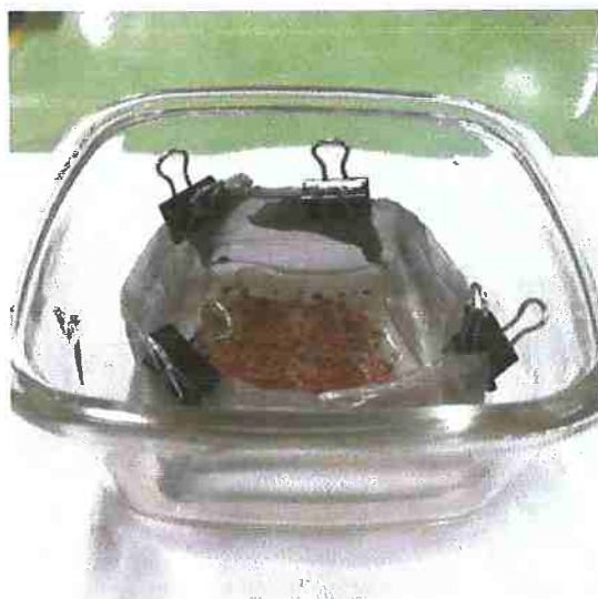
Figura 23 Peneira imersa em óleo vegetal, adicionada de argila com polpa de celulose
