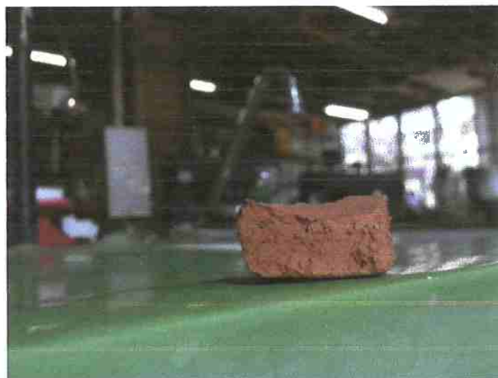
Figura 17. Perfil da peça de argila e polpa de celulose após 24 horas em estufa a 60 °C
