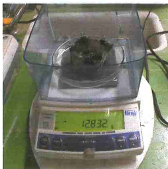
Figura 25. Aferindo o peso do conjunto cesta, óleo vegetal retido e 1 g de argila expandida para determinação do teste de absorção.
