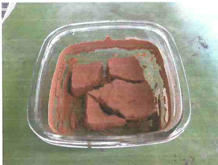
Figura 16. Peça de argila e polpa de celulose após 24 horas em estufa a 60 °C
