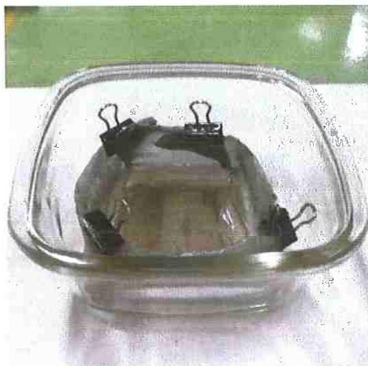
Figura 22. Peneira imersa em óleo vegetal, para realizar a tara na balança.
