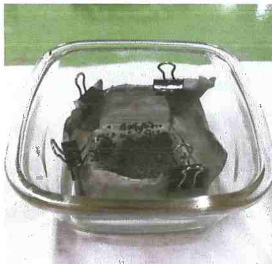
Figura 24. Peneira imersa em óleo vegetal, adicionada de argila expandida
