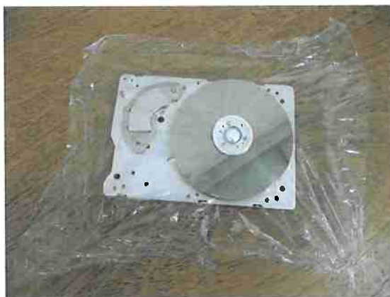
Figura 23: Filme de PVC aplicado sobre o HD.
