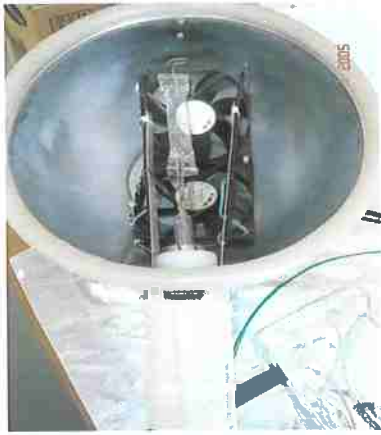
Figura 3(a): Visão interna do reator (refletor) de UV-Ozônio com a lâmpada e as ventoinhas.
