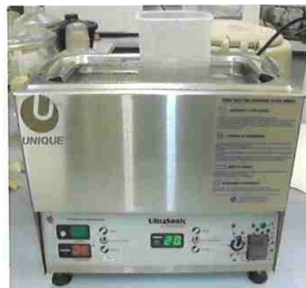
Figura 2(b): Banho ultrassônico e o frasco com o porta-amostra.
