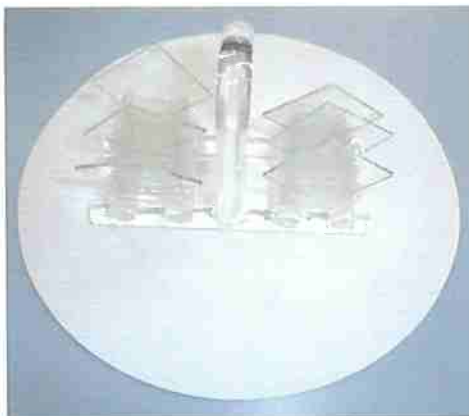
Figura 2(a): Lâminas no porta-amostra para serem submersas nos reagentes.
