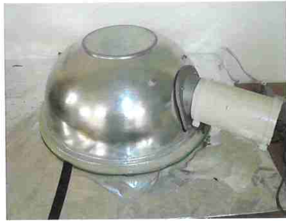
Figura 3(a): Visão externa do reator de UV-Ozônio.
