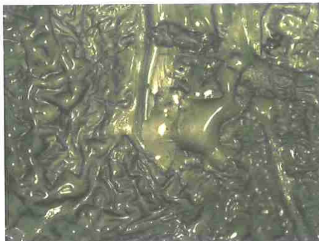
Figura 14: Superfície do adesivo epóxi com secagem em 2 minutos, sobre uma lâmina de vidro.
