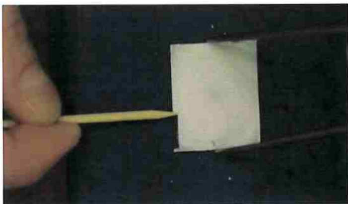
Figura 30(a): Remoção do material das bordas com um palito de madeira.
