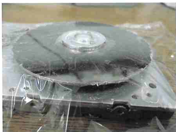
Figura 24 (a): Filme de PVC aplicado sobre o HD.
