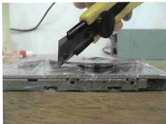
Figura 24 (b): Filme de PVC sendo cortado na borda do disco rígido.
