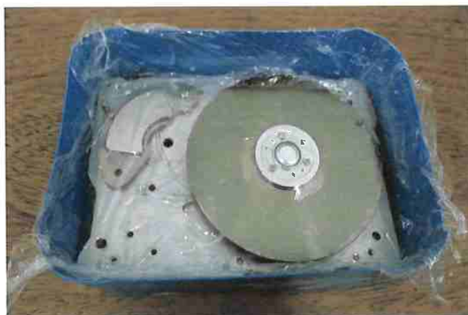
Figura 25: HD já revestido na caixa também revestida com filme de PVC.
