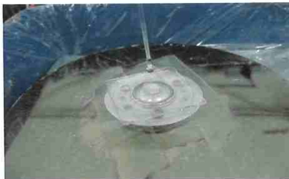
Figura 27(b): Deposição da solução de PVA sobre a lâmina de vidro.
