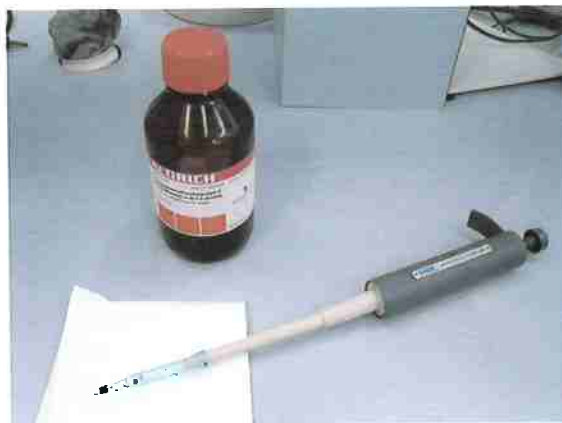
Figura 4: Frasco de PEDOT:PSS e pipetador de volume fixo para aplicá-lo.
