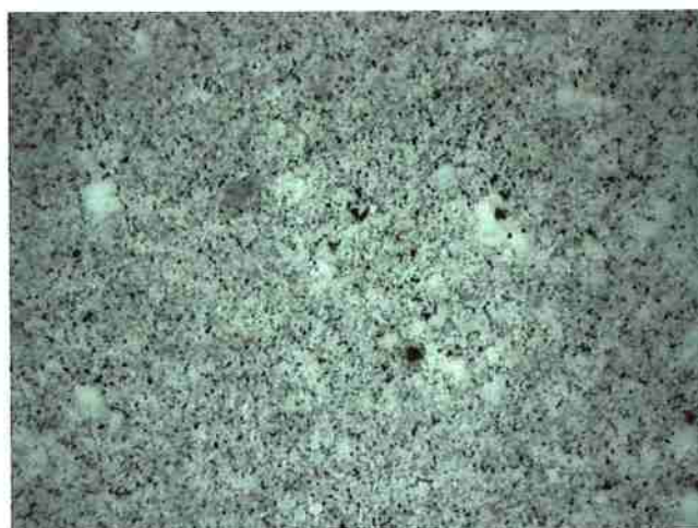
Figura 20: Lâmina preparada com deposição da solução do PVA e álcool metílico, seguida do acionamento do motor e posterior aplicação do secante.
