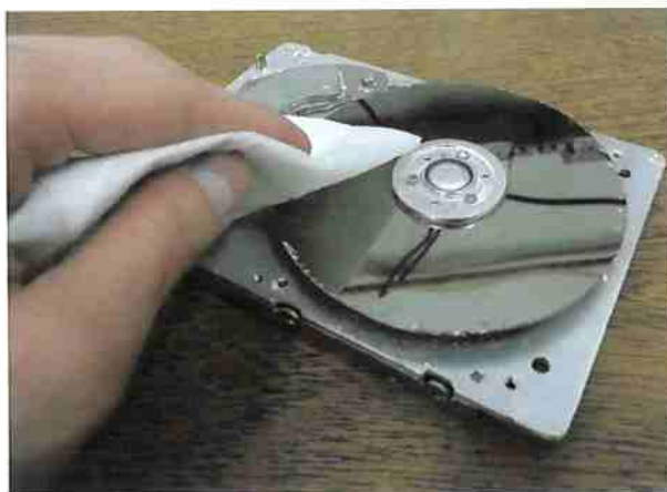
Figura 22: HD desmontado e umedecido com papel embebido em água.
