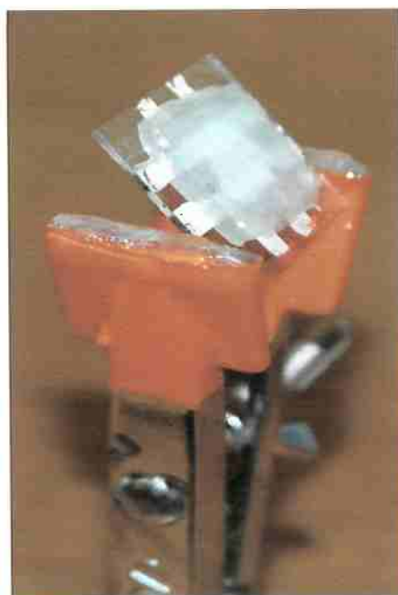
Figura 12: Aparência de um dispositivo P-OLED com um tipo de encapsulamento.
