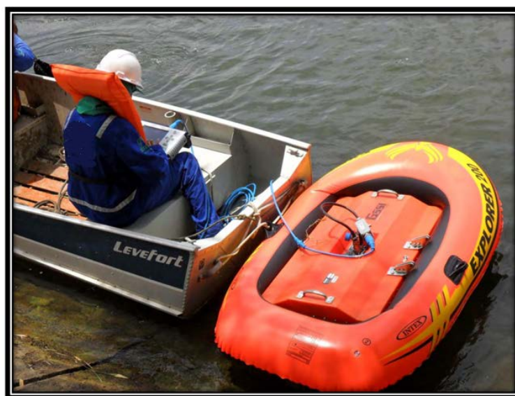
Figura 10: Equipamento GSSI utilizado na aquisição geofísica - GPR 3D.
