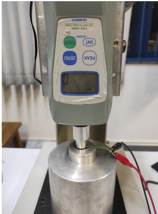
Figura 40 – Experimento utilizado para caracterização do FSR. Fonte: Autoria própria
