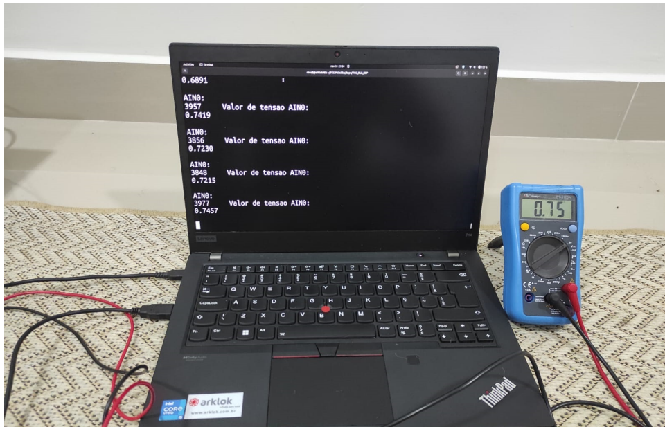
Figura 81 – Aplicação de um peso de 60kg - Sensor Circular.Fonte:Autoria própria.
