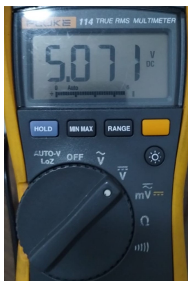
Figura 83 – Tensão positiva de 5V. Fonte: Autoria Própria
