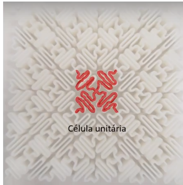
Figura 25 – Célula básica do metamaterial usada no vestível - PLA (Poliácido láctico). Fonte: CTI-Renato Archer.
