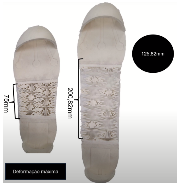
Figura 69 – Expansão e compressão do vestível. Fonte: CTI-Renato Archer
