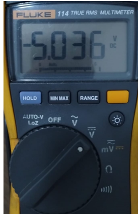
Figura 84 – Tensão negativa gerada de -5V. Fonte: Autoria Própria
