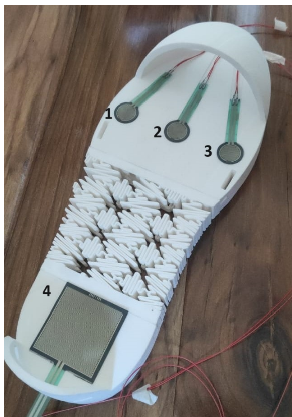
Figura 87 – Localização de cada sensor na palmilha. Fonte: Autoria própria
