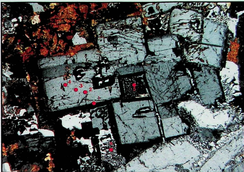
Figura 8G – Localização dos pontos de análises em cristal de plagioclásio zonado, e granófiros, indicando a variação composicional entre o núcleo e borda. No diorito de granulação muito grossa, textura intergranular às vezes subofítica. Tabela V, análises 1 e 4, amostra IGN4.2.H e Tabela VI, análises 5 e 6. Polarizadores cruzados, tamanho do lado maior 2,6 \mu\text{m} .
