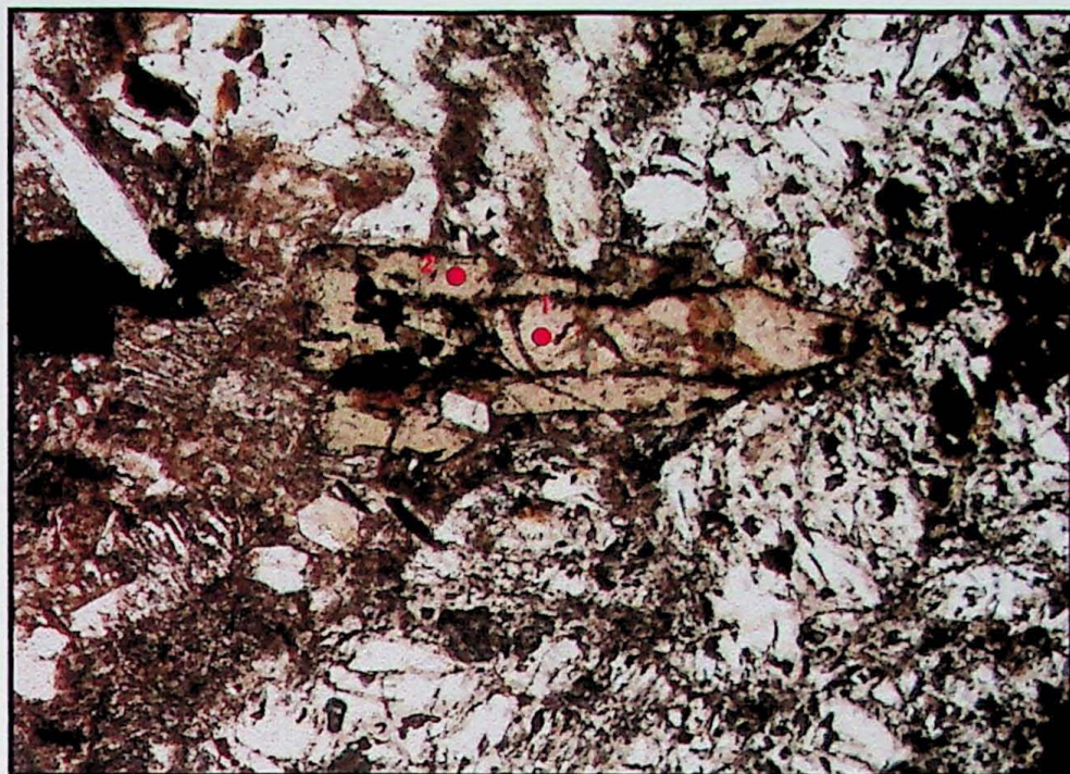
Figura 8E – Localização dos pontos de análises em cristal de piroxênio com núcleo de pigeonita corroídos por augita na borda. Em diorito de granulação muito grossa, textura intergranular às vezes subofítica. Tabela IV, análises 5 e 6, amostra IGN4.2.M. Polarizador inferior, tamanho do lado maior 2,6 \mu\text{m} .
