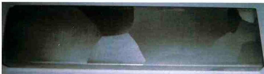
Figura 9 - Macrografia do lingote T.EXP-01-2/07 – Baixo Si.
