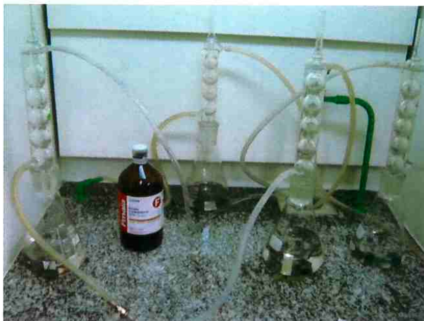
Figura 7 - Configuração experimental para ensaio de perda de massa.
